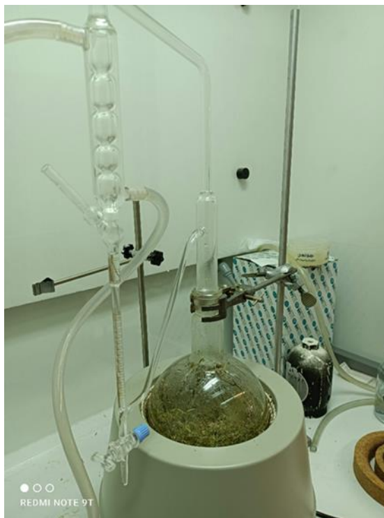
Εικόνα 21: Πειραματική διάταξη υδραπόσταξης λεβάντας
