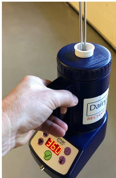
ΕΙΚΟΝΑ 48: Συσκευή ελεγχόμενης απόψυξης σπέρματος (Penn State Extension, 2013)
