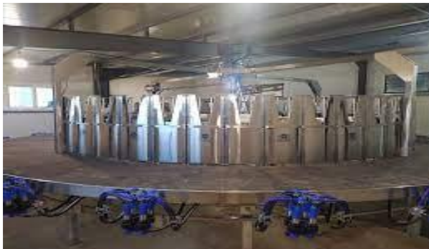
Εικόνα 9. Σταθερό αυτόματο αρμεκτήριο τύπου Carousell με την θέση του αρμεκτή προς τα έξω ( https://www.agro24.gr/agrotika/efodia/mihanimata-trakter/exoteriko-peristrofiko-armektirio-aigoprovaton-100-theseon-apo-ti ).
