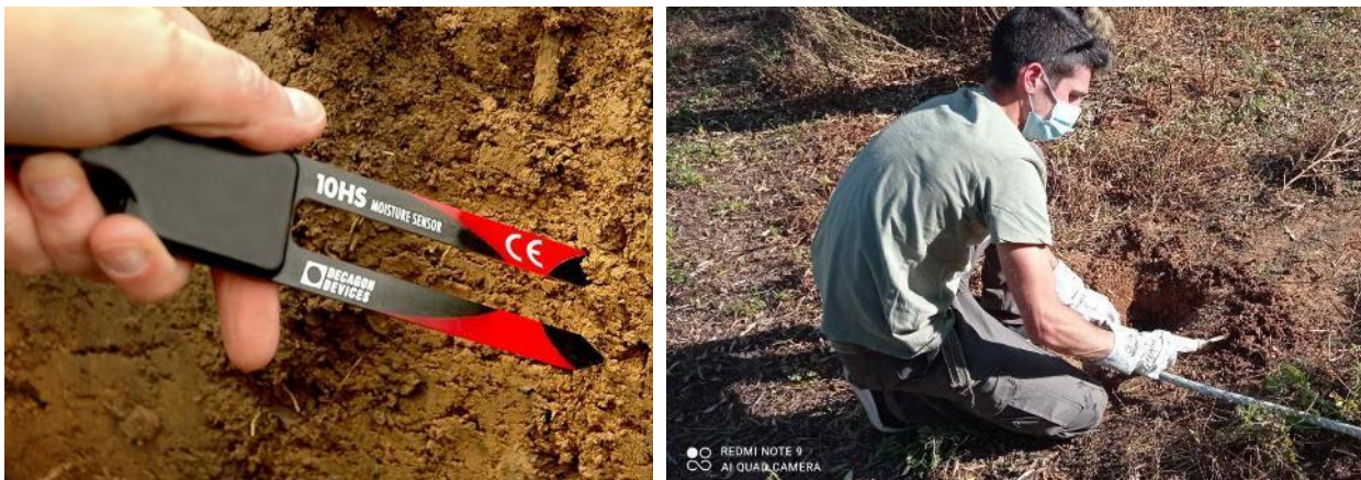
Εικόνα 7.6 Αισθητήρας υγρασίας και εγκατάσταση αισθητήρα
