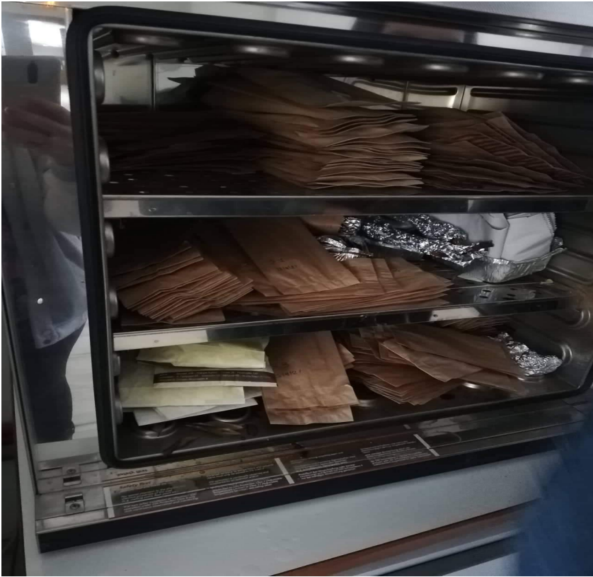
Εικόνα 5.3.1 Φούρνος αποξήρανσης φύλλων στους 50 βαθμούς Κελσίου.
