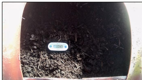
Εικόνα 5.10: Μέτρηση θερμοκρασίας του κομπόστ
