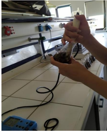
Εικόνα 5.7: Μέτρηση pH και EC
