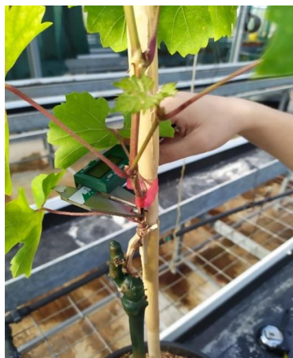
Εικόνα 5.16: Μέτρηση διαμέτρου με παχύμετρο
