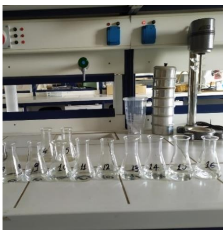
Εικόνα 5.5: Εισαγωγή κομπόστ σε κωνική φιάλη των 250 ml με 50ml απιονισμένου νερού
