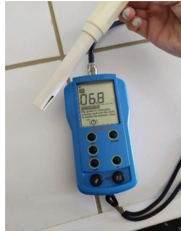
Εικόνα 5.8: Πεχάμετρο - Αγωγιμόμετρο Hanna HI 9811 - 51
