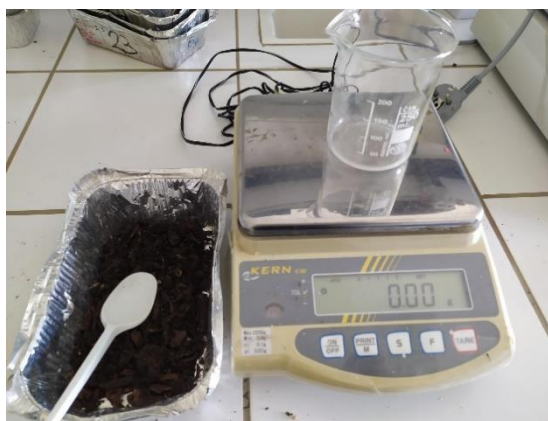
Εικόνα 5.3: Ζύγιση κομπόστ σε ηλεκτρονική ζυγαριά ακριβείας KERN EW
