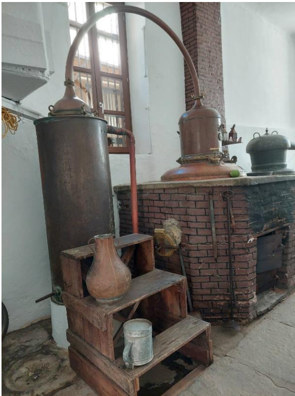
Εικόνα 42. Αποστακτήρας της ποτοποιίας «Η Αριάδνη Μ.Γ Βαλληνδρά».
