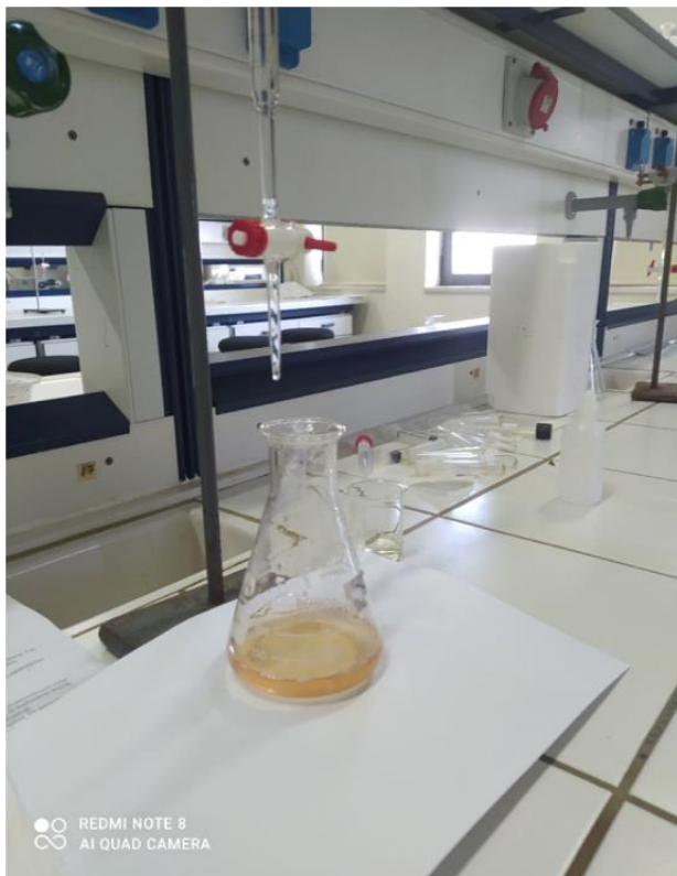
Εικόνα 16. Τελικό σημείο ογκομέτρησης εξουδετέρωσης κιτρικού οξέος.
