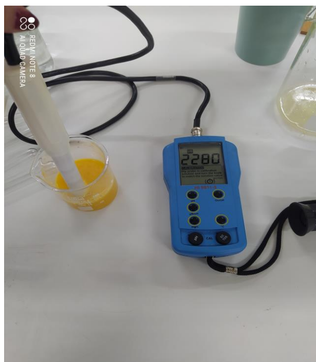
Εικόνα 14. Μέτρηση pH χυμού με πεχάμετρο
