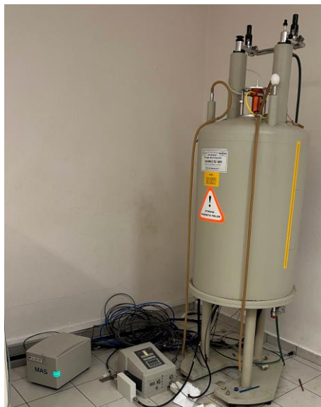
Εικόνα 65: Απεικόνιση της διάταξης του φασματομέτρου SSNMR Avance II 500 για δείγματα στερεής φάσης, που πραγματοποιήθηκαν οι μετρήσεις στην συγκεκριμένη διατριβή.
