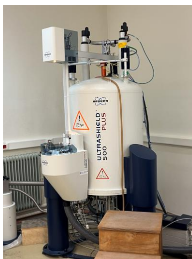
Εικόνα 64: Απεικόνιση της διάταξης του φασματομέτρου NMR Avance II 500 για δείγματα υγρής φάσης, που πραγματοποιήθηκαν οι μετρήσεις στην συγκεκριμένη διατριβή.
