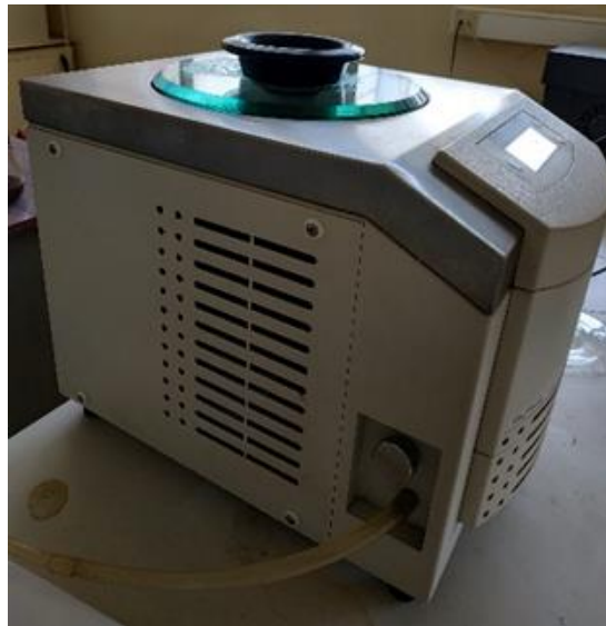
Εικόνα 70: Λυοφιλοποιητής Christ-Alpha 1-2LD που χρησιμοποιήθηκε για την ξήρανση στερεών υλικών στην διατριβή.
