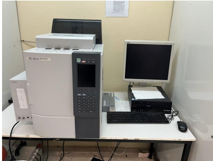
Εικόνα 48: Αέριος χρωματογράφος συζευγμένος με TCD ανιχνευτή Shimadzu GC-2014, που χρησιμοποιήθηκε για μετρήσεις στη συγκεκριμένη διατριβή.
