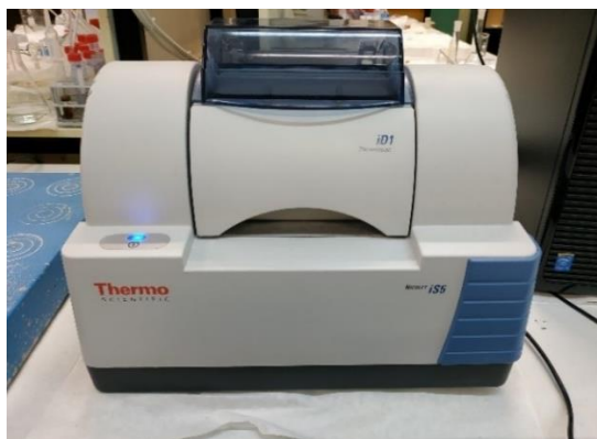
Εικόνα 51: Φασματοφωτόμετρο Fourier-Transform (FT) IR Nicolet IS5 που πραγματοποιήθηκαν οι μετρήσεις FT-IR για τη συγκεκριμένη διατριβή.
