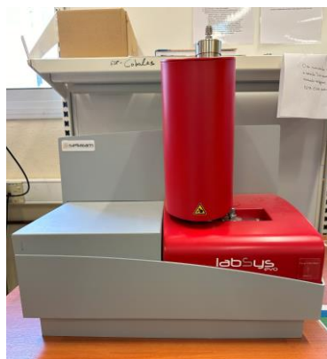
Εικόνα 58: Όργανο labSys ενo 1150 °C της Setaram που χρησιμοποιήθηκε για τη θερμοβαρυμετρική ανάλυση και τη λήψη φασμάτων στη συγκεκριμένη διατριβή.
