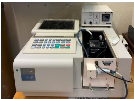
Εικόνα 60: Φασματοφωτόμετρο UV-Vis, Hitachi U-2900 που χρησιμοποιήθηκε για τη λήψη φασμάτων UV-Vis στη συγκεκριμένη διατριβή.
