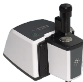
Εικόνα 53: Φασματοφωτόμετρο Agilent Cary 360 FT-IR, συνδεδεμένο με το εξάρτημα ZnSe-ATR που χρησιμοποιήθηκε για την λήψη φασμάτων ATR στην συγκεκριμένη διατριβή.
