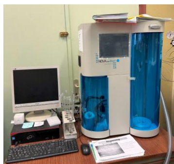
Εικόνα 61: Ποροσίμετρο Quantachrome NOVAtouch LX2 που χρησιμοποιήθηκε για τη λήψη μετρήσεων στη συγκεκριμένη διατριβή.
