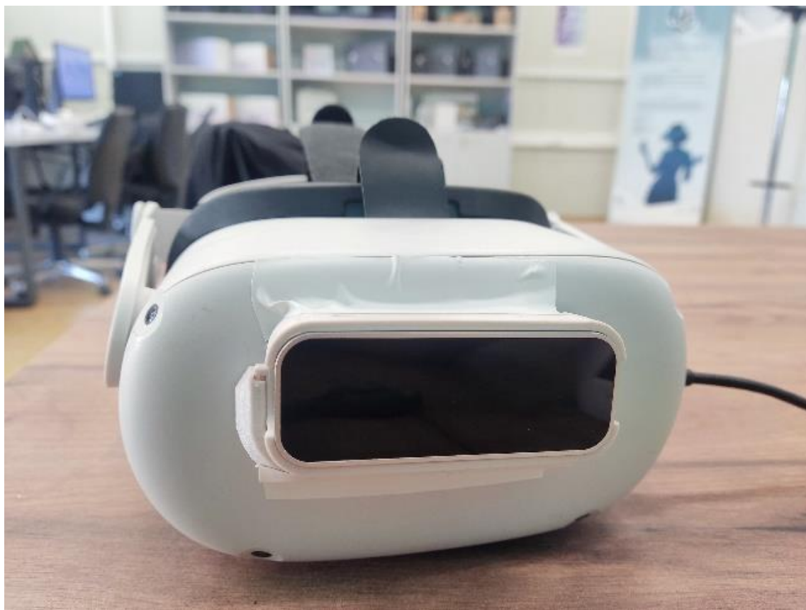
Εικόνα 65: Τοποθέτηση του Leap σε Meta Quest 2
