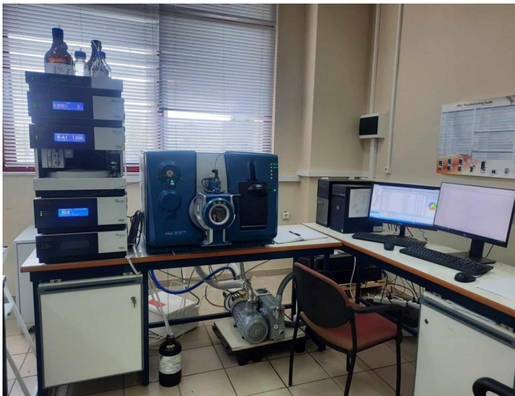
Εικόνα 25. Η διάταξη LC-MS/MS που χρησιμοποιήθηκε στην παρούσα διατριβή. Στα αριστερά απεικονίζεται το μηχάνημα UHPLC και στα δεξιά το φασματόμετρο μάζας Triple Quad.
