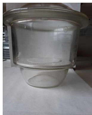
Εικόνα 29. Τοποθέτηση του μέσου FPSE στον ξηραντήρα, μετά τη διαδικασία επικάλυψης.
