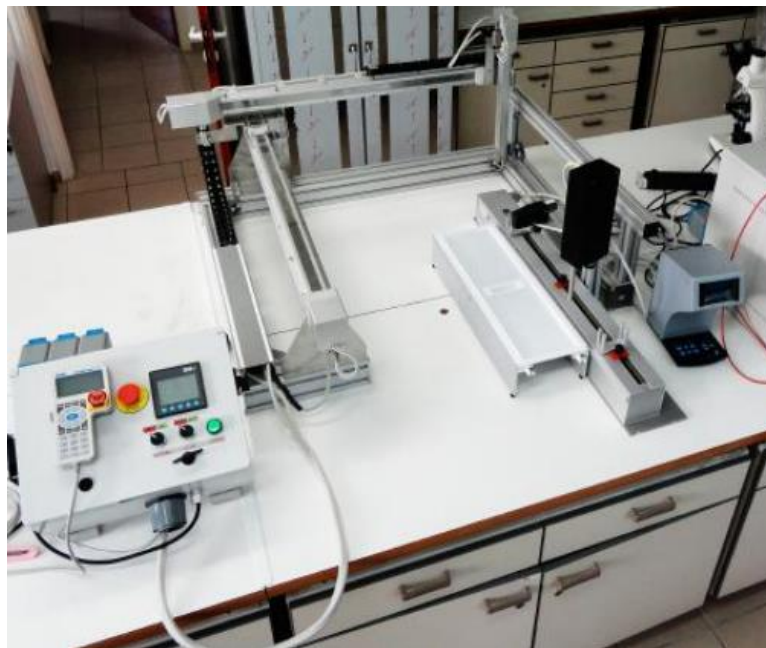
Σχήμα Γ5.2: Συσκευή Langmuir Blodgett και καρτεσιανό ρομποτικό σύστημα (LB).
