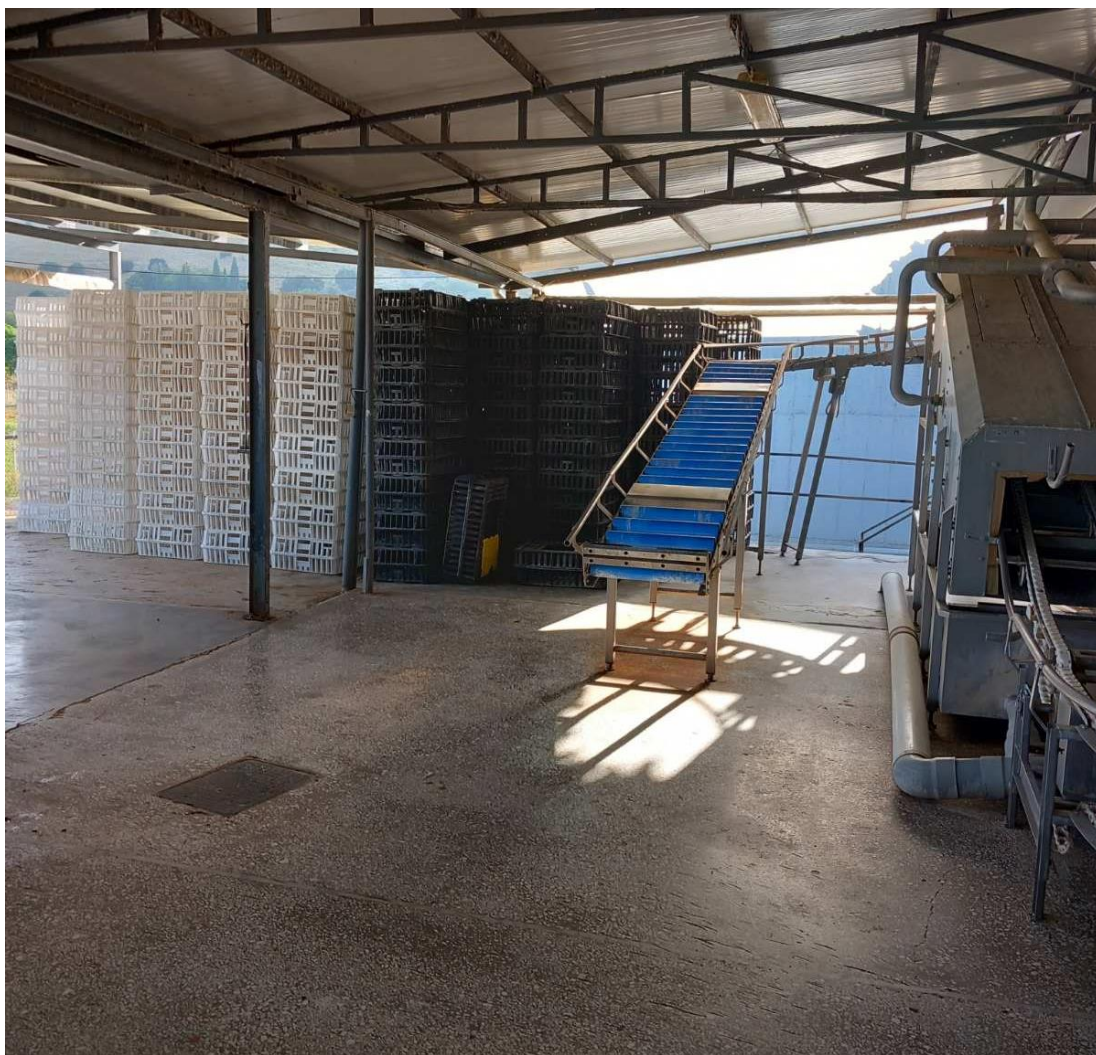
Εικόνα Β3. 8 Πτην. Β-Χώρος παραλαβής πτηνών και συσκευή πλύσης κλωβών μετά το τέλος των εργασιών καθαριότητας
