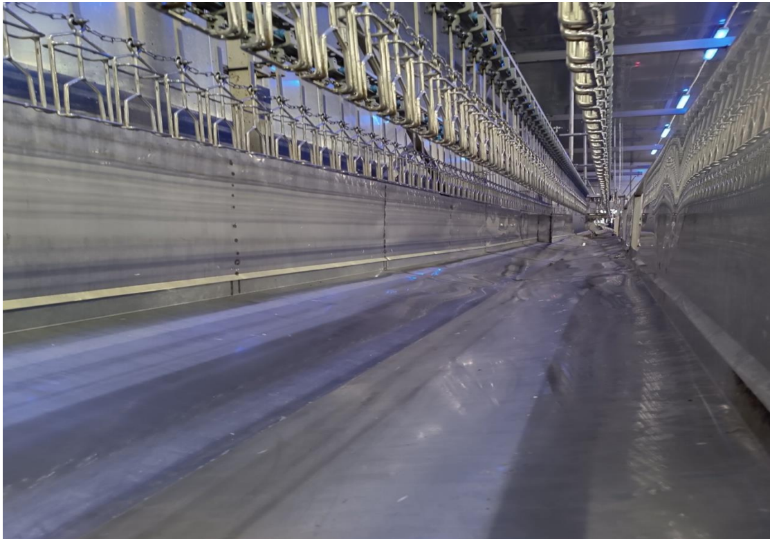
Εικόνα Β2. 2 Πτηνοσφαγείο Α-Συσκευή αφαίμαξης, μετά το καθάρισμα, έτοιμη για την σφαγή.
