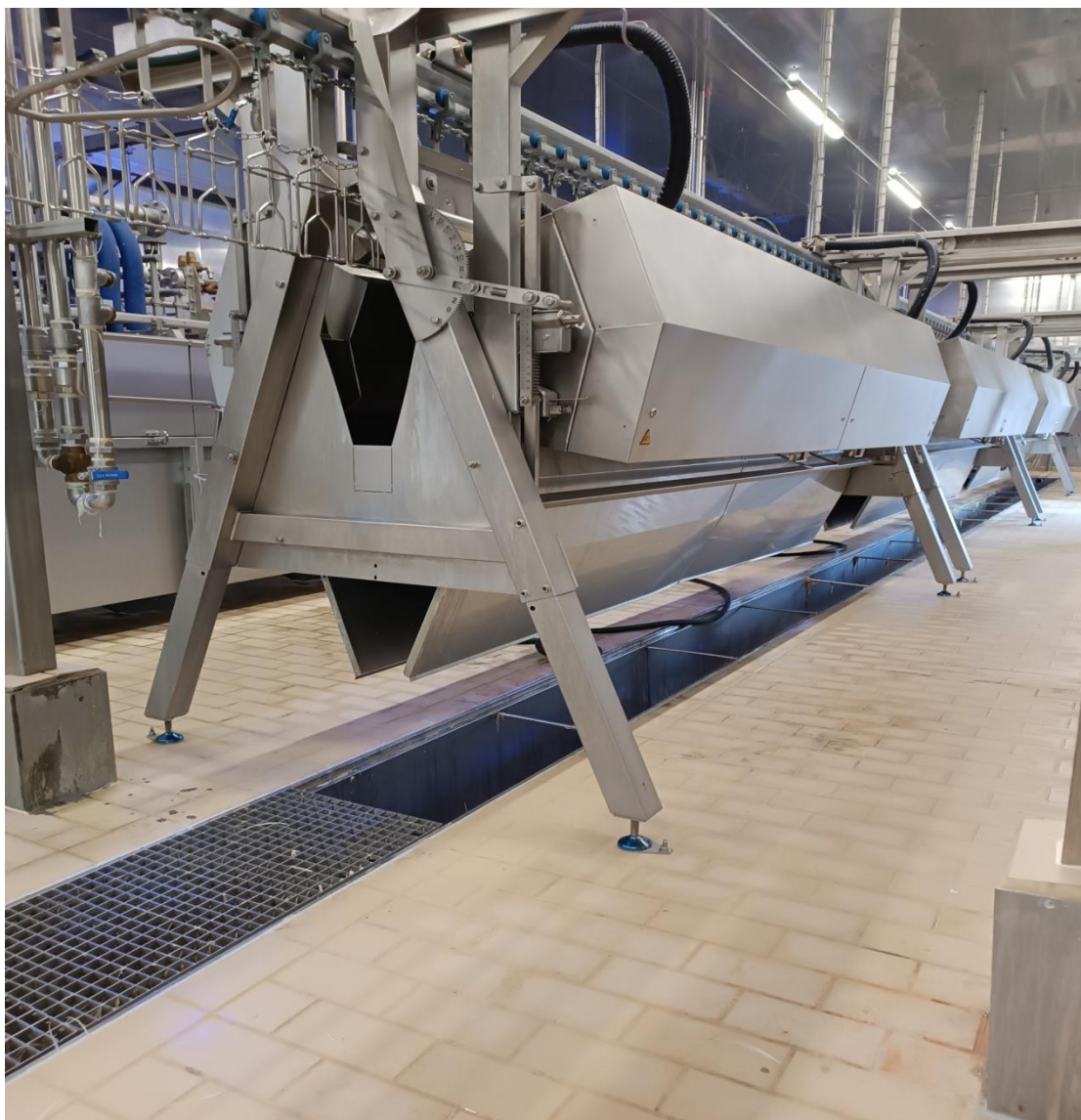
Εικόνα Β2. 3 Πτηνοσφαγείο Α-Συσκευή αποτίλλωσης, μετά το καθαρίσμα, έτοιμη για την έναρξη της σφαγής.
