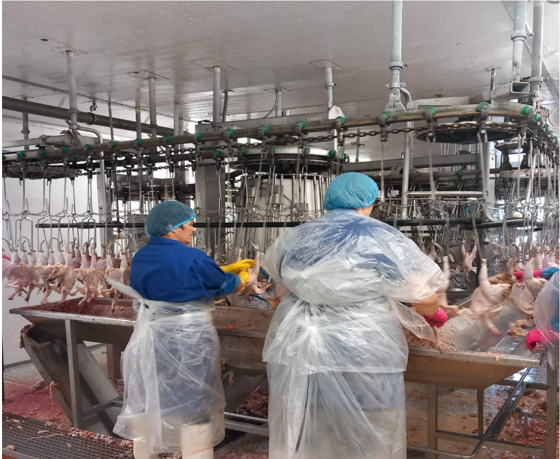
Εικόνα Β3. 6 Πτηνοσφαγείο Β-Απεντέρωση
