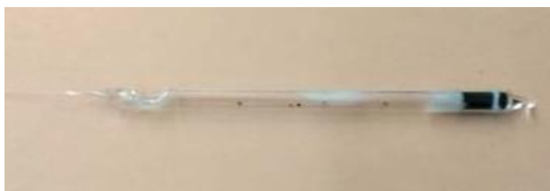
Εικόνα 4.2 Η σφραγισμένη κάψουλα χαλαζία με το μίγμα ενεργού άνθρακα/θείου υπό κενό, που χρησιμοποιήθηκε για τα δείγματα που παρασκευάστηκαν με τη μέθοδο «τήξης-διάχυσης».
