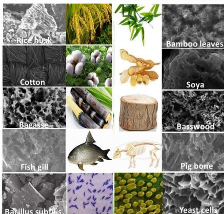
Εικόνα 2.5 Παραδείγματα ενεργών ανθράκων από βιομάζα και οι αντίστοιχες εικόνες ηλεκτρονικής μικροσκοπίας σάρωσης (SEM).[43]
