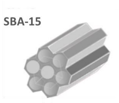
Εικόνα 2.9 Σχηματική αναπαράσταση μεσοπορώδους πυριτικής δομής SBA-15.[79]
