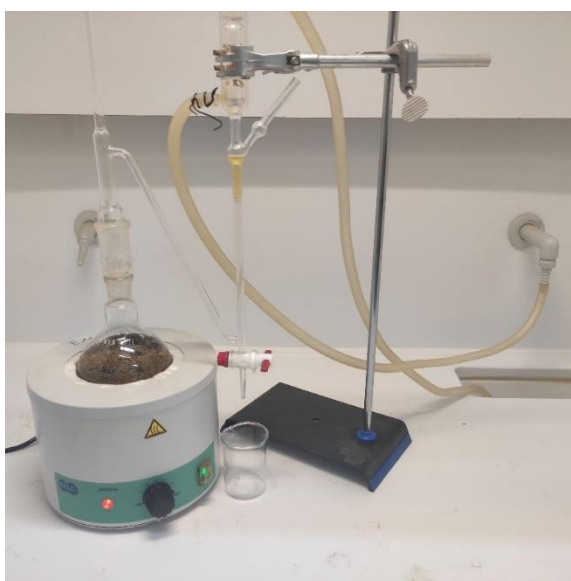
Εικόνα 11. Εργαστηριακή συσκευή απόσταξης αιθέριων ελαίων τύπου Clevenger (Εργαστήριο Χημείας Τροφίμων, Πανεπιστήμιο Ιωαννίνων, 2020).
