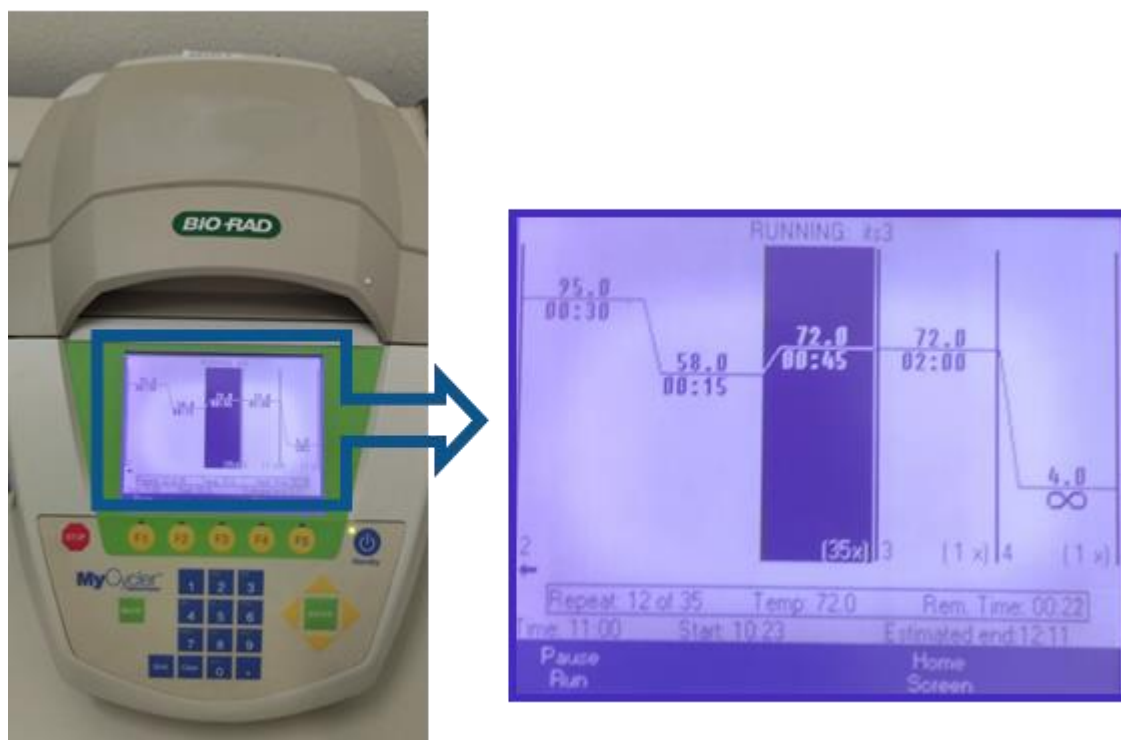
Εικόνα Γ-6. Θερμικός κυκλοποιητής BioRad MyCycler Thermal Cycler και το πρόγραμμα που χρησιμοποιήθηκε κατά τη διαδικασία PCR για την ενίσχυση της ITS περιοχής (Εργαστήριο Παραγωγικής Γεωργίας και Φυτοϋγείας, Τμήμα Γεωπονίας, Πανεπιστήμιο Ιωαννίνων, 2022).
