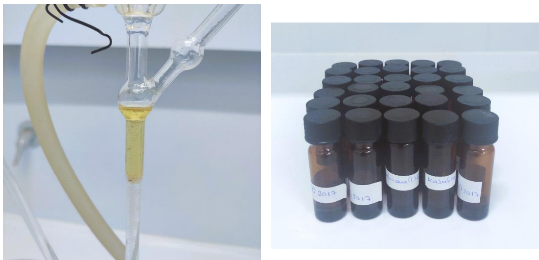
Εικόνα Γ-2. Αριστερά: Βαθμονόμηση στη συσκευή Clevenger που χρησιμοποιήθηκε για τη μέτρηση του όγκου του παραγόμενου αιθέριου ελαίου των δειγμάτων. Δεξιά: Φιαλίδια που χρησιμοποιήθηκαν για την αποθήκευση των αιθέριων ελαίων μετά τη διαδικασία του φιλτραρίσματος (Εργαστήριο Χημείας Τροφίμων, Πανεπιστήμιο Ιωαννίνων, 2020).
