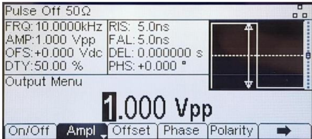
Εικόνα Π1.2 : Ρύθμιση της τάσης εξόδου της γεννήτριας.
