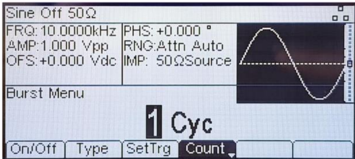
Εικόνα Π1.4 : Ρύθμιση του αριθμού των επαναλήψεων του πακέτου παλμών.
