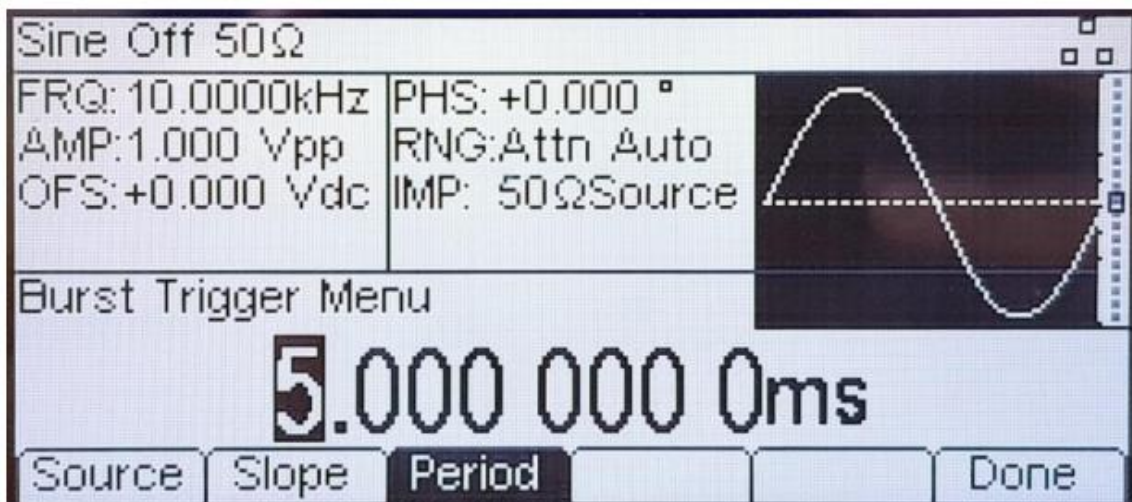
Εικόνα Π1.5 : Ρύθμιση της περιόδου επανάληψης του πακέτου παλμού.
