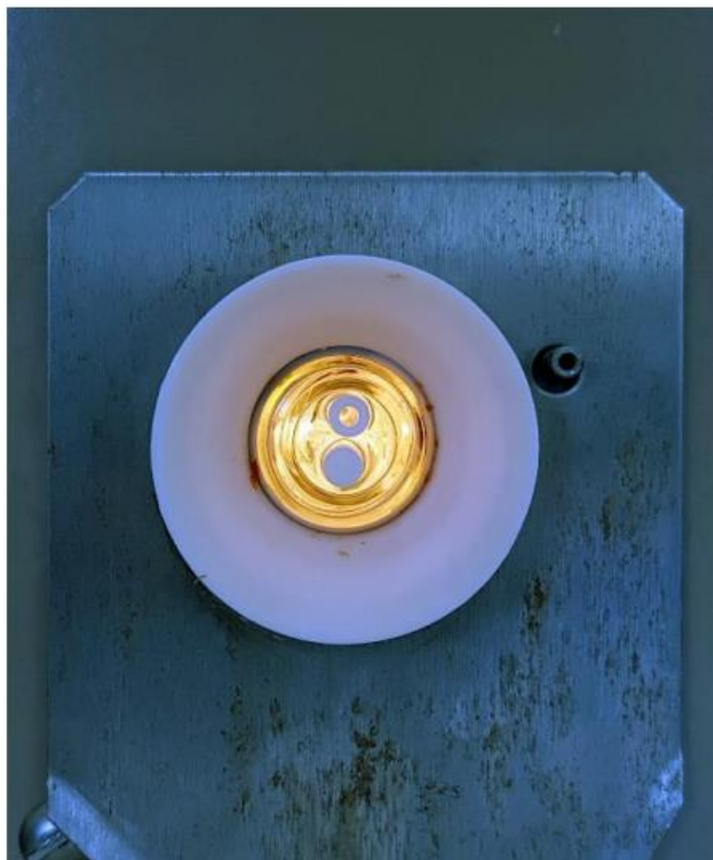
Εικόνα Π4.2 : Δεξιά όψη του πυκνόμετρου. Η πάνω οπή χρησιμεύει για την εισαγωγή του δείγματος στο σωλήνα, ενώ η κάτω οπή, η οποία διαθέτει κλειστό καπάκι, για την απομάκρυνσή του. Δεξιά του διακρίνεται η έξοδος της αντλίας του αέρα.
