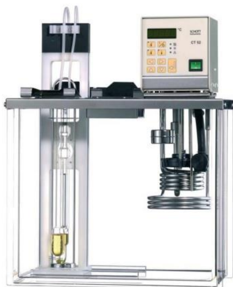
Εικόνα Π3.1: Το σύστημα μέτρησης ιξώδους. Φαίνονται το υδατόλουτρο, ο θερμοστάτης καθώς και η βάση μέτρησης του ιξώδους, η οποία συνδέεται με το τερματικό μέτρησης για την καταγραφή του χρόνου ροής.
