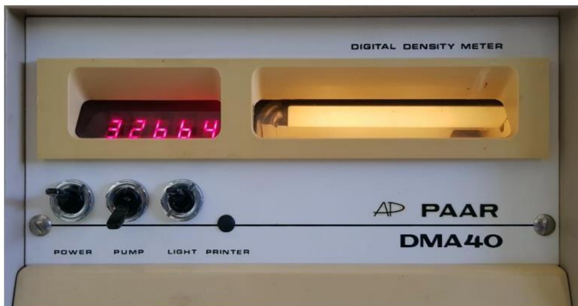
Εικόνα Π4.1 : Η μπροστινή όψη του πυκνόμετρου. Διακρίνεται ο φωτιζόμενος θάλαμος μέτρησης του δείγματος, η οθόνη μέτρησης καθώς και οι τρεις διαθέσιμοι διακόπτες για το άνοιγμα του οργάνου, της λυχνίας και της αντλίας αέρα.
