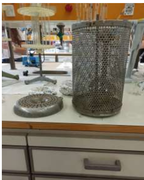
Εικόνα 23 Απεικόνιση των μεταλλικών κανίστρων που χρησιμοποιήθηκαν για την τοποθέτηση των αντίστοιχων φίλτρων pest και pharm- pocis στο θαλασσινό νερό.
