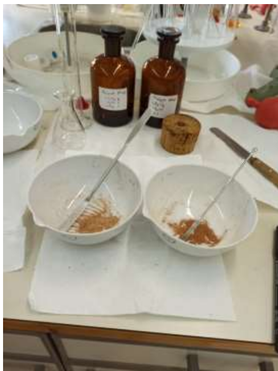
Εικόνα 26 Το προσροφητικό υλικό των POCIS μετά την εξάτμιση του απεσταγμένου νερού. Όπως φαίνεται και στην εικόνα το κίτρινο υλικό (αριστερά) είναι το HLB που χρησιμοποιήθηκε για την ανίχνευση των φαρμακευτικών ενώσεων και το πιο καφετί χρώμα (δεξιά) αντιστοιχεί στο τριφασικό μίγμα ( Isolute ENV+ polystyrene divinylbenzene + άνθρακας Ambersorb 1500 διεσπαρμένος σε βιοκλίνες S-X3 για την ανίχνευση των φυτοπροστατευτικών ενώσεων, αντίστοιχα.
