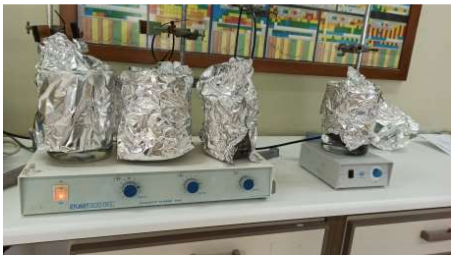
Εικόνα 30 Βαθμονόμηση των συσκευών POCIS και εύρεση των κινητικών προσρόφησης υπό σταθερές συνθήκες. Ανάδευση σε απιονισμένο νερό ( T = 12^{\circ} \text{C} )
