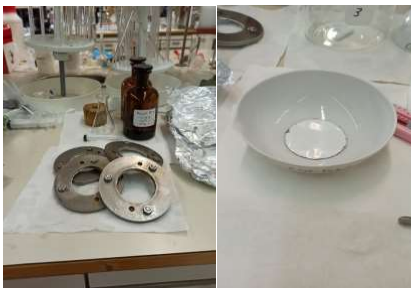
Εικόνα 25 Αφαίρεση της μεμβράνης PES από τις συσκευές POCIS και του προσροφητικού υλικού με τη χρήση ελάχιστου απεσταγμένου νερού.
