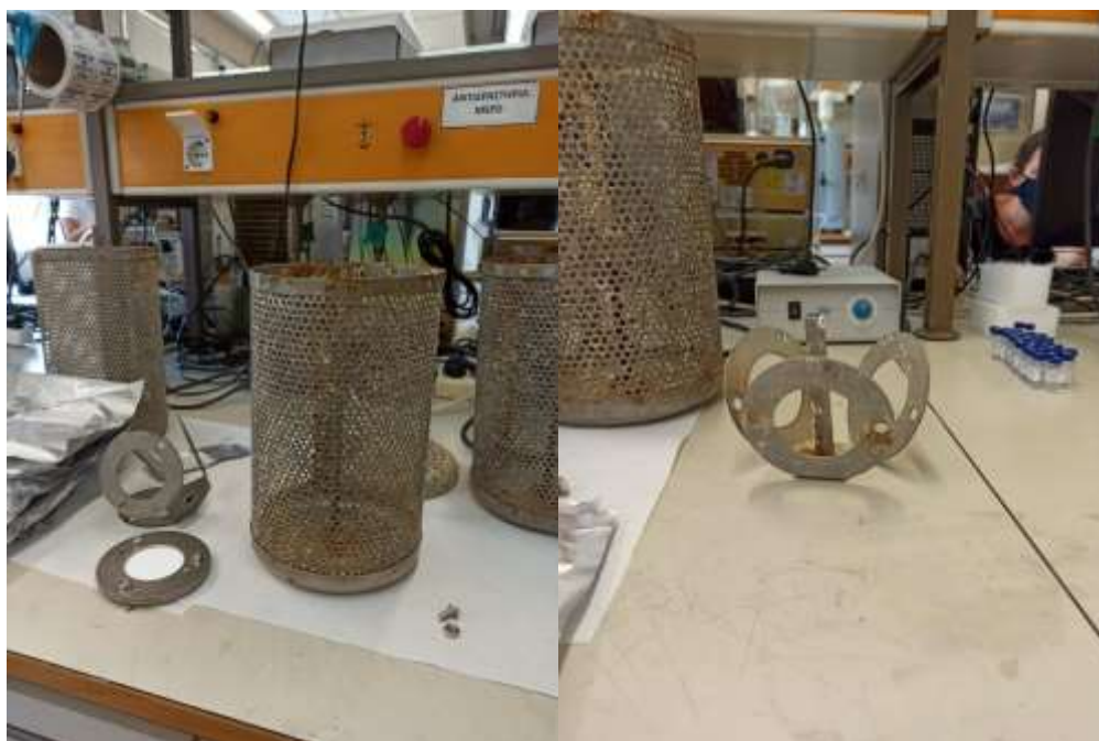
Εικόνα 22 Η συσκευή POCIS πριν από την εφαρμογή της στη βάση, στο κάνιστρο- κλουβί. Μετά την σωστή τοποθέτηση των συσκευών POCIS ακολούθησε η έκθεση τους στο θαλασσινό νερό για 21 ημέρες.
