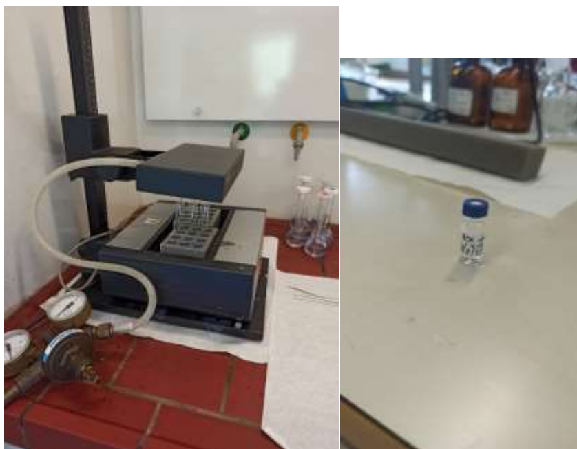
Εικόνα 29 Στο τελικό στάδιο έγινε συμπύκνωση μέχρι ξηρού με τη χρήση της συσκευής αζώτου του οίκου Techne (Staffordshire, United Kingdom) και επαναδιαλυτοποίηση των δειγμάτων σε τελικό όγκο 0,5 ml σε γυάλινα φιαλίδια των 2 ml όπως φαίνεται στην δεύτερη εικόνα.
