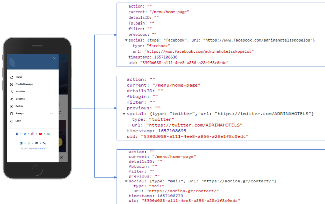
Εικόνα 5.15 Παράδειγμα δημιουργίας αντικειμένων clickstream μέσω της χρήσης των συνδέσμων σε υπηρεσίες κοινωνικής δικτύωσης
