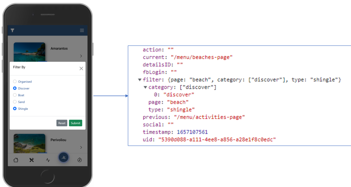
Εικόνα 5.13 Παράδειγμα ενέργειας του χρήστη και συγκεκριμένα εφαρμογής ενός φίλτρου αναζήτησης στην λίστα των παραλιών (αριστερό τμήμα) και δημιουργία του αντίστοιχου αντικειμένου clickstream (δεξιό τμήμα)
