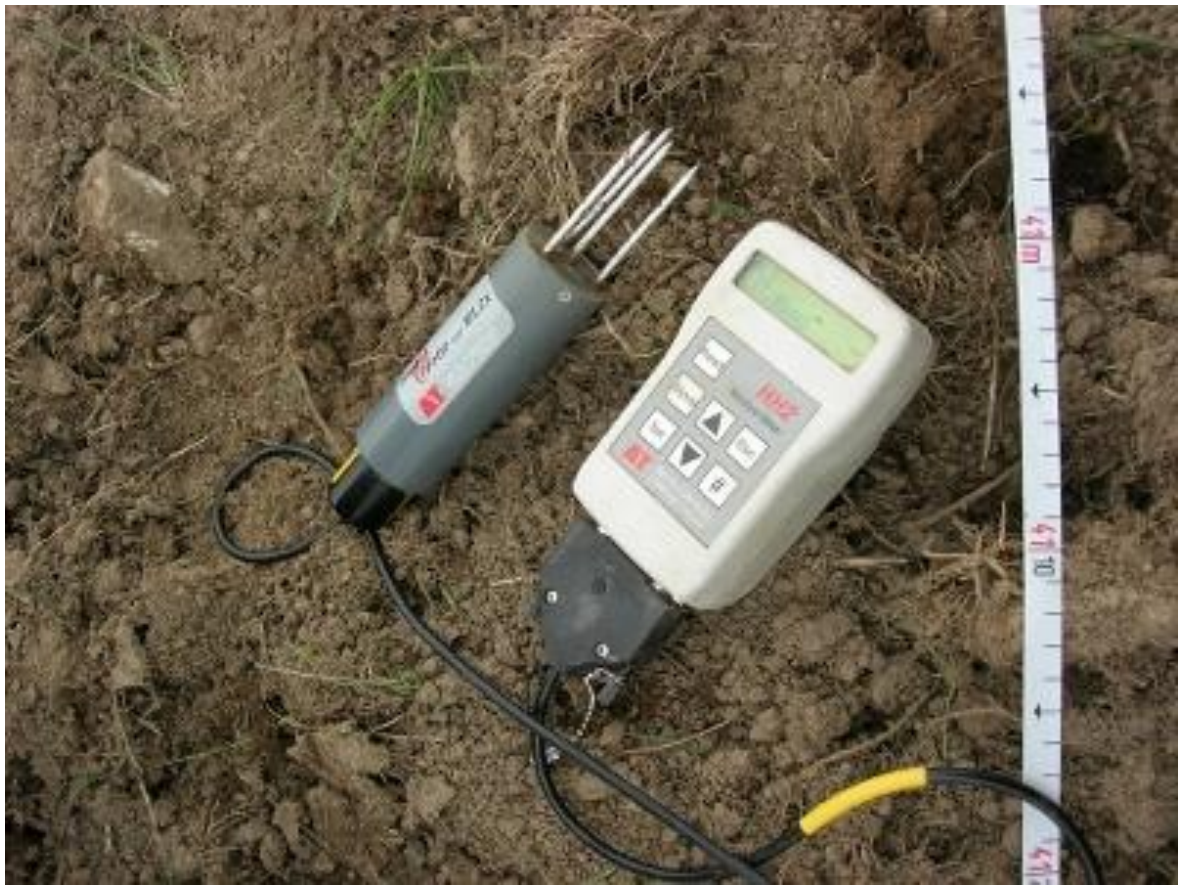
Εικόνα 4 Αισθητήρας μέτρησης υγρασίας εδάφους (κατασκευαστής ΔΤ, τύπος Thetaprobe ML2x) με καταγραφικό (HH2)
