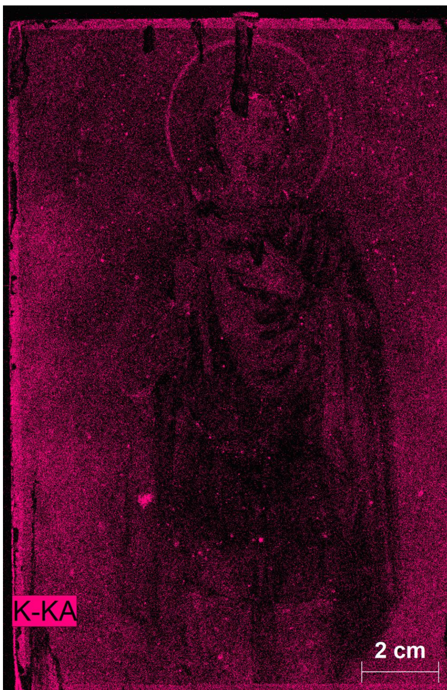
Σχήμα 98. Στοιχειακος χάρτης του καλίου από την ανάλυση με την βοήθεια του Μ6
