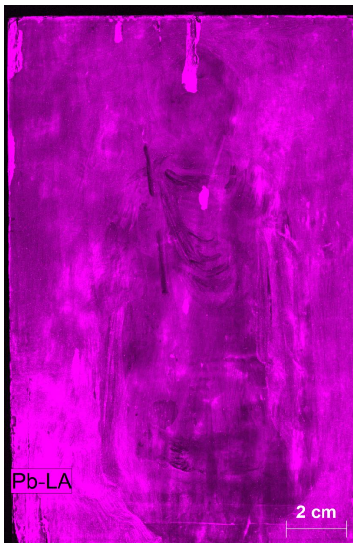
Σχήμα 95. Στοιχειακος χάρτης του μολύβδου από την ανάλυση με την βοήθεια του M6
