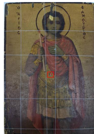
Σχήμα 65. Αριστερά) Φάσμα του σημείου 19 από το στοιχείο του Cu και η κορυφή του στα 8,046keV. Δεξιά) Η απεικόνιση του σημείου που μετρήθηκε με το όργανο πάνω στην εικόνα.
