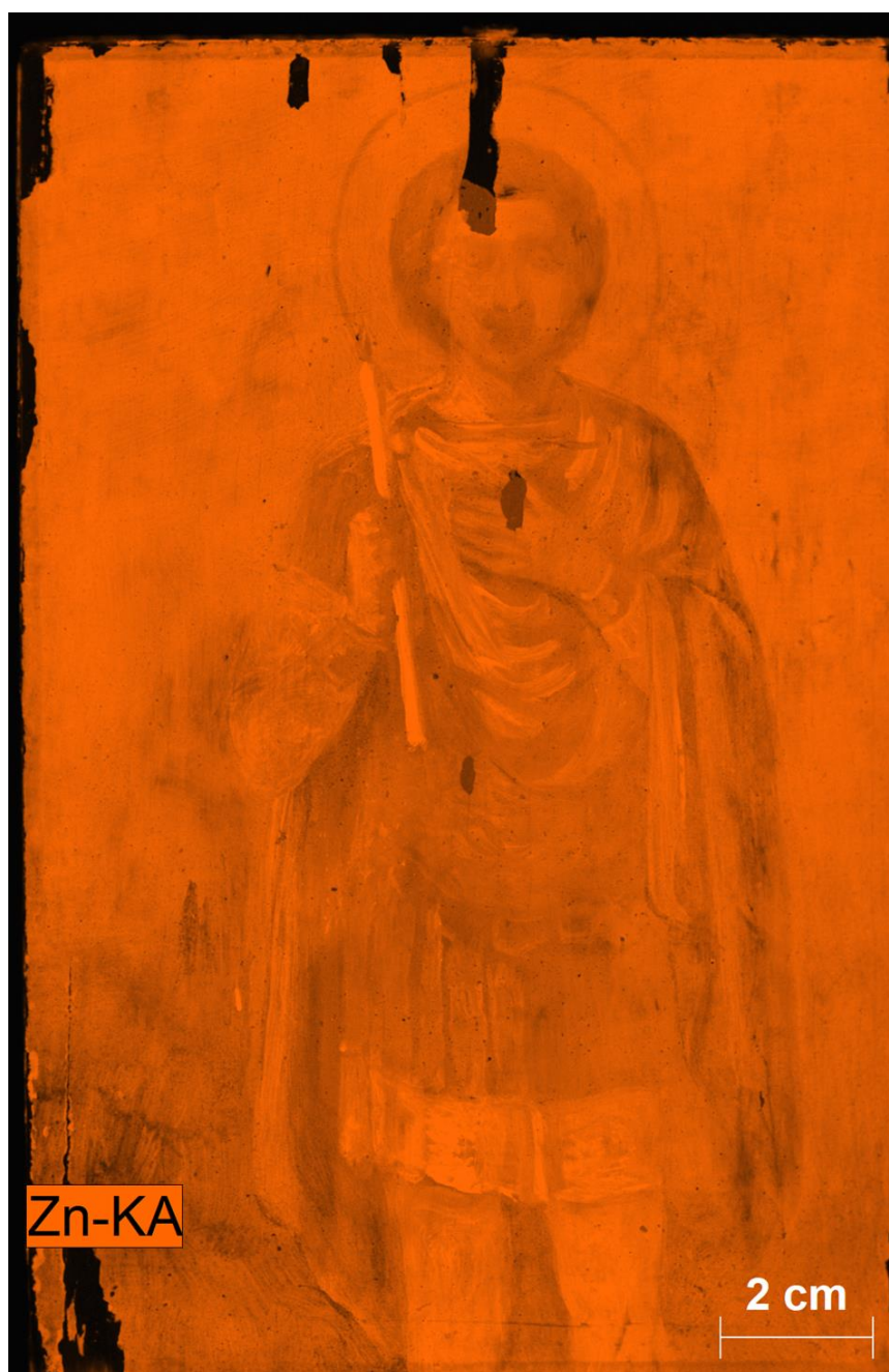
Σχήμα 93. Στοιχειακός χάρτης του ψευδαργύρου από την ανάλυση με την βοήθεια του M6
