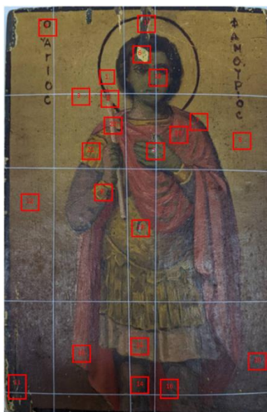
Σχήμα 42.Σημεία που μετρήθηκαν πάνω στην εικόνα με την βοήθεια του Tracer
