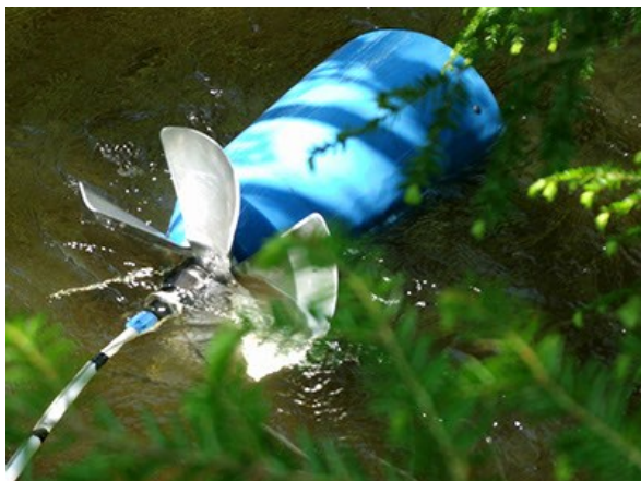
Εικόνα 11: Μηχανική αντλία RP-100
