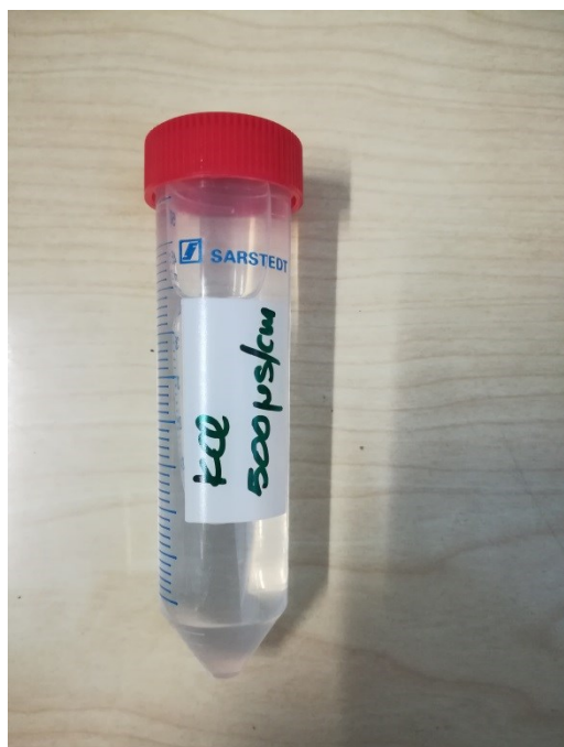
Εικόνα 50: Υδατικό διάλυμα γνωστής αγωγιμότητας 500 \mu\text{S/cm}
