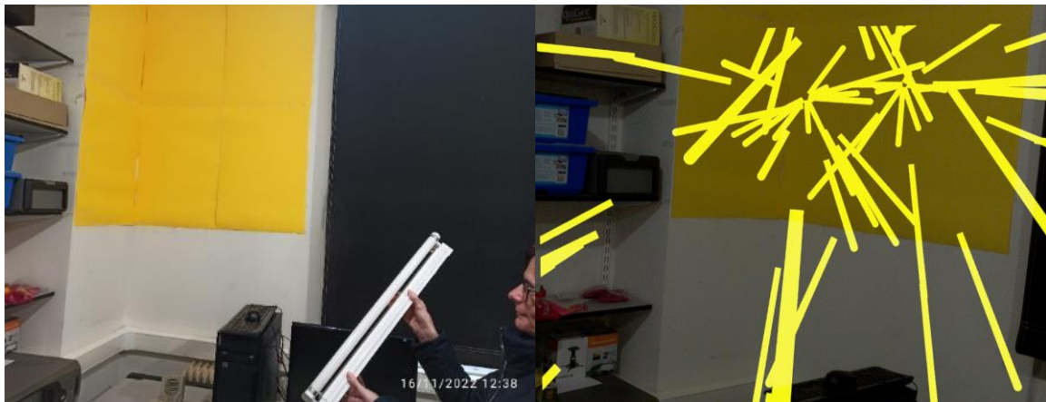
Σχήμα 6.14: Ο κίτρινος τοίχος και η λάμπα φθορισμού στον φυσικό χώρο (αριστερά) και μέσα από τα γυαλιά (δεξιά)
