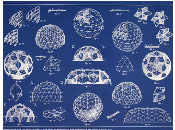
εικ.10 αρχετυπικά σχέδια του Fuller για τις γαιοδετικές δομές
