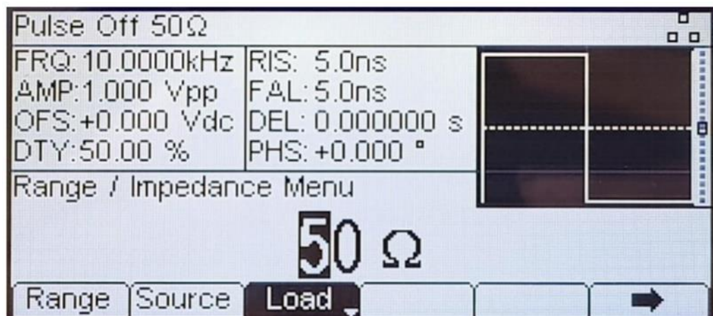
Εικόνα Π.1.3.1 Ρύθμιση αντίστασης εξόδου γεννήτριας στα 50Ω.
