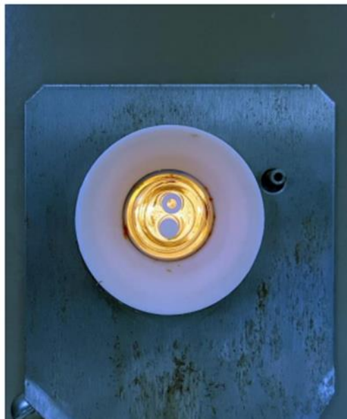
Εικόνα Π.2.1.1 Δεξιά όψη του οργάνου. Στο δεξί μέρος αυτών βρίσκεται η έξοδος αέρα για τον καθαρισμό του εσωτερικού του σωλήνα
