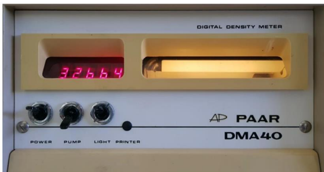
Εικόνα Π.2.1 Η όψη της συσκευής μέτρησης πυκνότητας. Διακρίνονται οι διαθέσιμοι διακόπτες, η οθόνη μέτρησης και ο φωτιζόμενος θάλαμος μέτρησης του δείγματος
