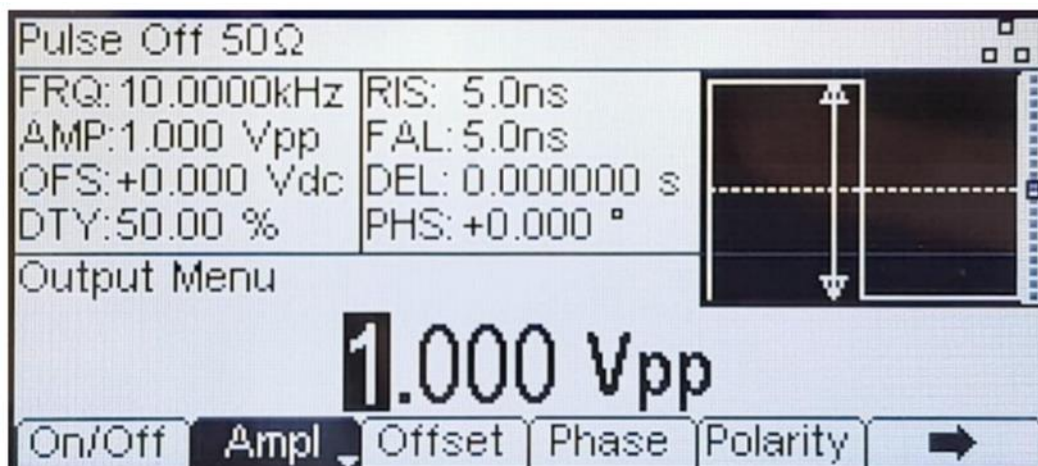
Εικόνα Π.1.3.2 Ρύθμιση της τάσης εξόδου της γεννήτριας
