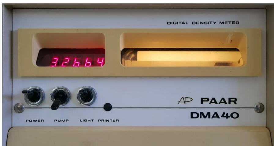
Εικόνα Π4.1 Το όργανο μέτρησης της πυκνότητας. Διακρίνεται ο φωτιζόμενος σωλήνας, η ένδειξη του βάρους, καθώς και οι τρεις διακόπτες για το άνοιγμα του οργάνου (Power), της λυχνία (Light) και της αντλίας αέρα (Pump).
