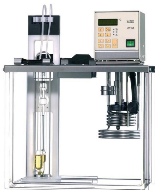
Εικόνα Π3.1 Το σύστημα μέτρησης ιξώδους. Τα κομμάτια που το απαρτίζουν είναι το υδατόλουτρο, ο θερμοστάτης που συνδέεται με εξωτερικό σύστημα ψύξης, η βάση του οργάνου που συνδέεται από το πίσω μέρος της με τερματικό, και ο σωλήνας μέτρησης.
