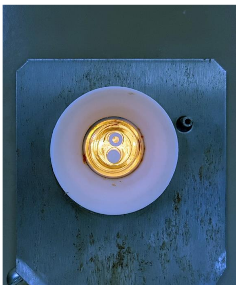
Εικόνα Π2.2 Πλάγια όψη του οργάνου μέτρησης της πυκνότητας. Η πάνω οπή αποσκοπεί στην πλήρωση του σωλήνα με το δείγμα, ενώ η κάτω στην απομάκρυνση του δείγματος. Η κάτω οπή διαθέτει κλειστό άσπρο καπάκι. Δεξιά της άνω οπής φαίνεται η έξοδος της αντλίας αέρα.
