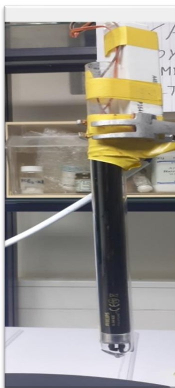
Εικόνα 38. Λάμπα ακτινοβολήσης αιωρημάτων ισχύος 6 Watt
