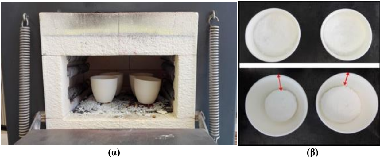
Εικόνα 16: (α) Τοποθέτηση δειγμάτων στο φούρνο και (β) σκόνη πριν (πάνω) και μετά (κάτω) τη διαδικασία απανθράκωσης, όπου φαίνεται ξεκάθαρα η διαφορά στον όγκο της σκόνης πριν και μετά το στάδιο της απανθράκωσης.
