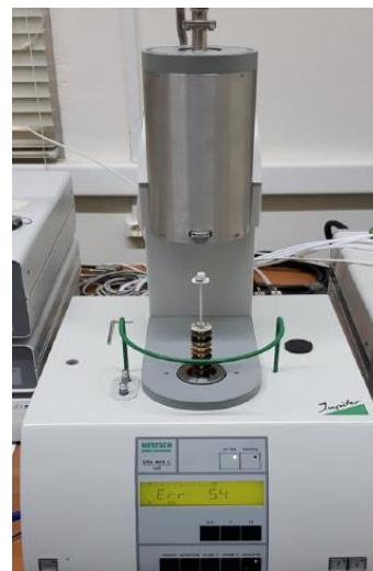
Εικόνα 23. Πειραματική διάταξη θερμικής θερμιδομετρίας σάρωσης (DSC, STA 449 C, Netzsch, Selb Germany)
