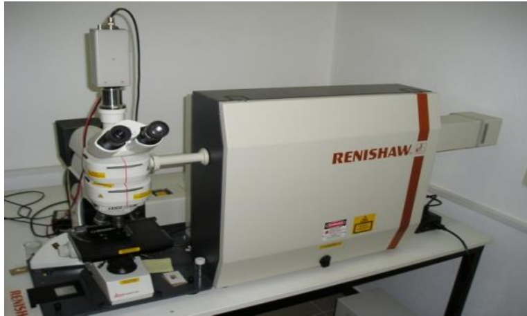
Εικόνα 21: Πειραματική διάταξη φασματοσκοπίας Raman ((RM 1000 Renishaw, Wotton-under-Edge, England)
