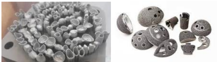
Εικόνα 2. (α) Οδοντιατρικές και (β) Ορθοπεδικές προσθετικές αποκαταστάσεις κατασκευασμένες με την τεχνολογία CAD/CAM.
