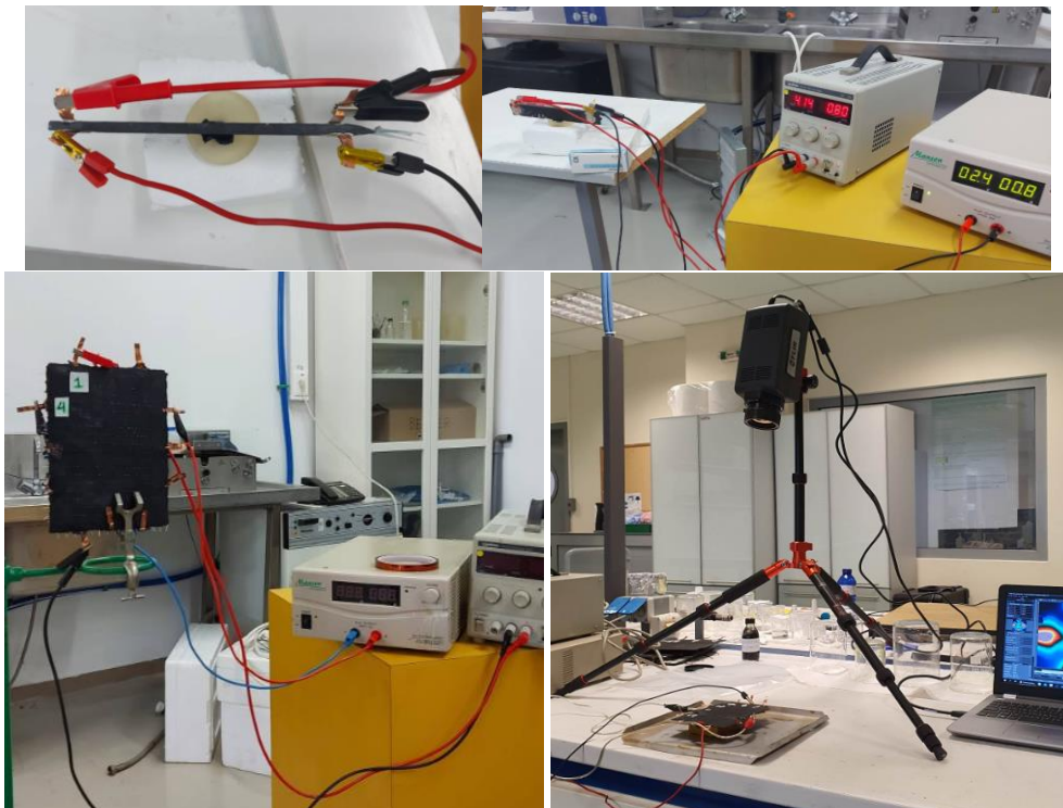
Σχήμα 7.11 Θέρμανση με Joule Heating με εφαρμογή ρεύματος
