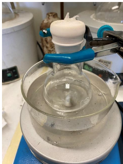
Σχήμα 7.12 Διαδικασία υδρόλυσης με θερμοστατημένο λουτρό
