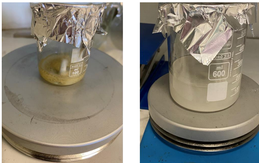
Σχήμα 7.8 Διαδικασία απομάκρυνσης καταλυτικού συστήματος.
