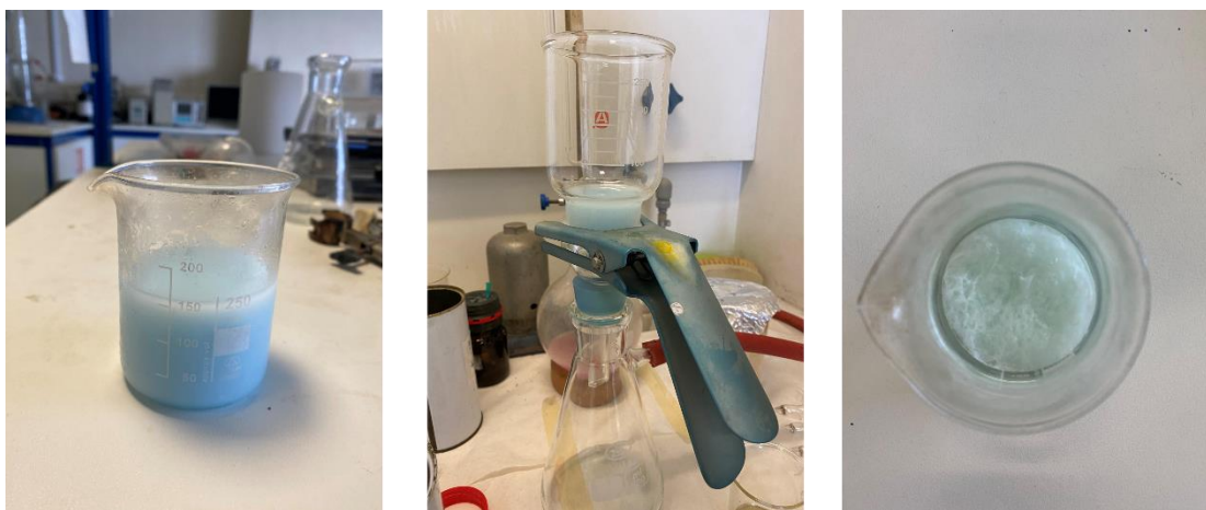
Σχήμα 7.7 Καταβύθιση του δείγματος - Διάταξη Buchner - Προϊόν καταβύθισης.
