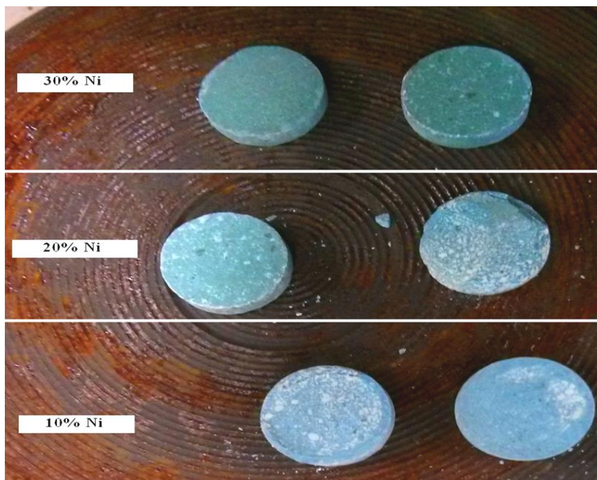
Σχήμα 2.2.4: Σύνθετα Ni-Al 2 O 3 μετά από ψήσιμο στους 900 °C για 532h
