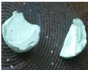
Σχήμα 3.1.2.2: Θραύση δοκιμίου σύστασης 20% Ni/Al 2 O 3 κατά τα πρώτα στάδια θέρμανσης στους 900 °C, στην οποία αποδίδεται η πτωτική τάση της καμπύλης 20% Ni_2 του Σχήματος 3.1.2.1 (α)
