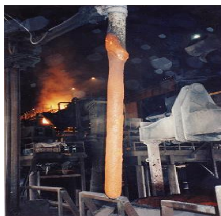
Σχήμα 1.6.3.7: Σωλήνα (καλυμμένη με κυρίως αλουμινικά πυρίμαχα) έκχυσης παραγόντων αποθείωσης και αερίων προκειμένου να αυξηθεί η ποιότητα του μετάλλου [94]
