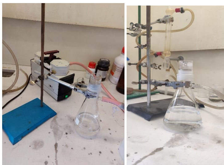
Εικόνα 3.4 :Αντλία και κωνική φιάλη που χρησιμοποιήθηκαν για τη διήθηση (αριστερά) και σύστημα κενού με θρύση (δεξιά)
