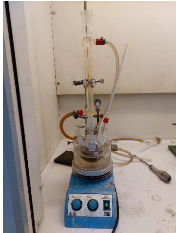
Εικόνα 3.6 : Διάταξη θέρμανσης υπό αναρροή(reflux)
