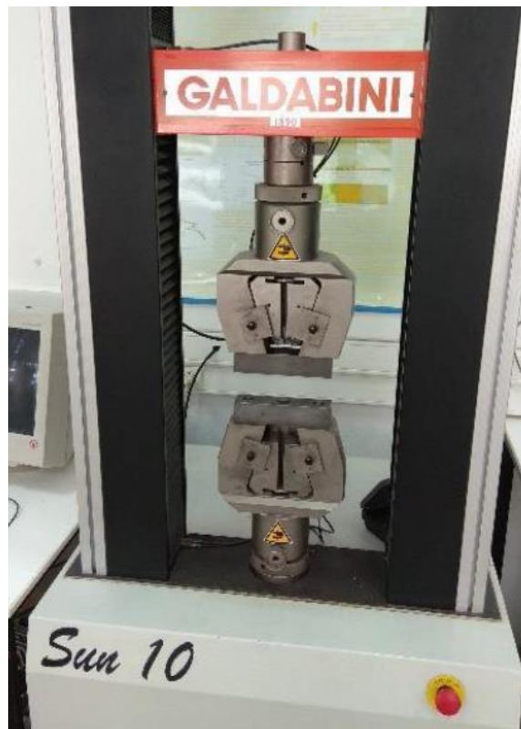
Εικόνα 28 Μηχάνημα εφελκυσμού Galdabini Sun 10 (με τις ενσωματωμένες βάσεις για τις δοκιμές θλίψης).
