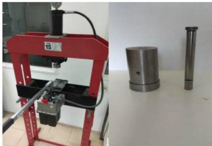
Εικόνα 21 Ομοαξονική πρέσα του Εργαστηρίου Εφαρμοσμένης Μεταλλουργίας και ειδικά διαμορφωμένο καλούπι για κατασκευή των πελετών.
