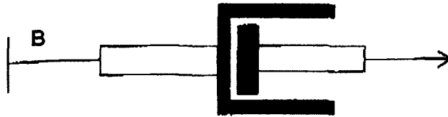
A: Το ελαστικό μοντέλο του Hooke (ελαστικότητα) B: Ο υδραυλικός αποσβεστήρας του Newton (γλοιότητα)
