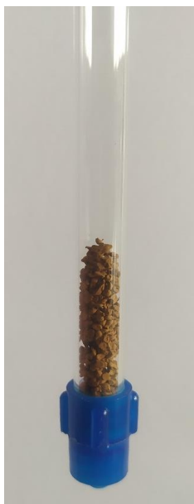
Εικόνα 22. Τα beads του σύνθετου υλικού \text{CA@SnS}_2/\text{H}_2\text{O} τοποθετημένα στην στήλη.
