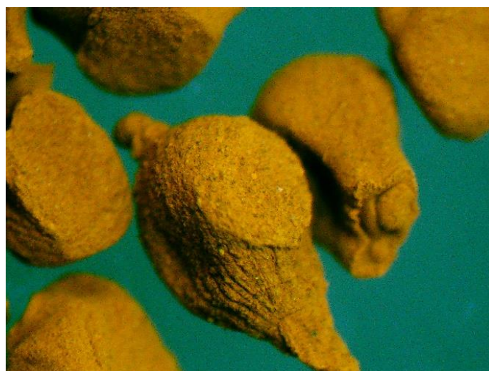
Εικόνα 21. Φωτογραφία μικροσκοπίου των στεγνών beads του σύνθετου υλικού \text{CA@SnS}_2/\text{H}_2\text{O} .
