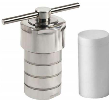
Εικόνα 5. Αυτόκλειστο δοχείο από αστάλι με Teflon που χρησιμοποιείται σε διαλυτοθερμικές και υδροθερμικές μεθόδους σύνθεσης.
