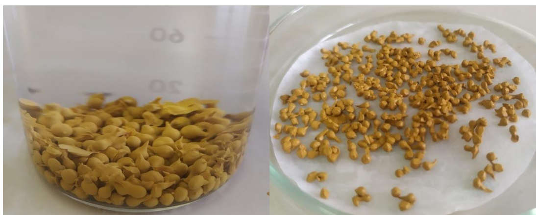
Εικόνα 20. Αριστερά: Τα beads του σύνθετου υλικού \text{CA@SnS}_2/\text{H}_2\text{O} στο λουτρό \text{CaCl}_2 , δεξιά: τα beads μετά την διήθηση.
