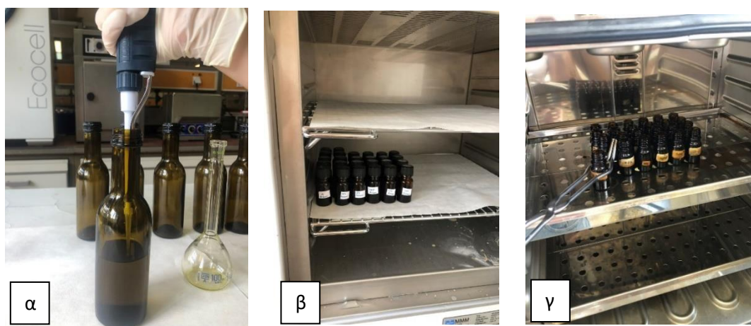
Εικόνα 17. α) Προσθήκη αιθέριου ελαίου ρίγανης σε ελαιόλαδο με αυτόματη πιπέτα β) Αποθήκευση δειγμάτων στους 50 °C γ) Θερμική επεξεργασία δειγμάτων στους 180 °C.
