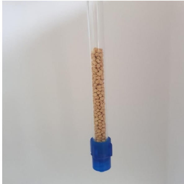
Εικόνα 3.36: Τα beads μετά τον 3 ο κύκλο ρόφησης. Είναι εμφανής η αλλαγή του χρώματος.
