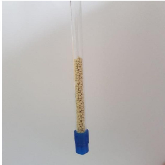
Εικόνα 3.33: Στήλη με πληρωτικό υλικό MOR-3@CA beads.
