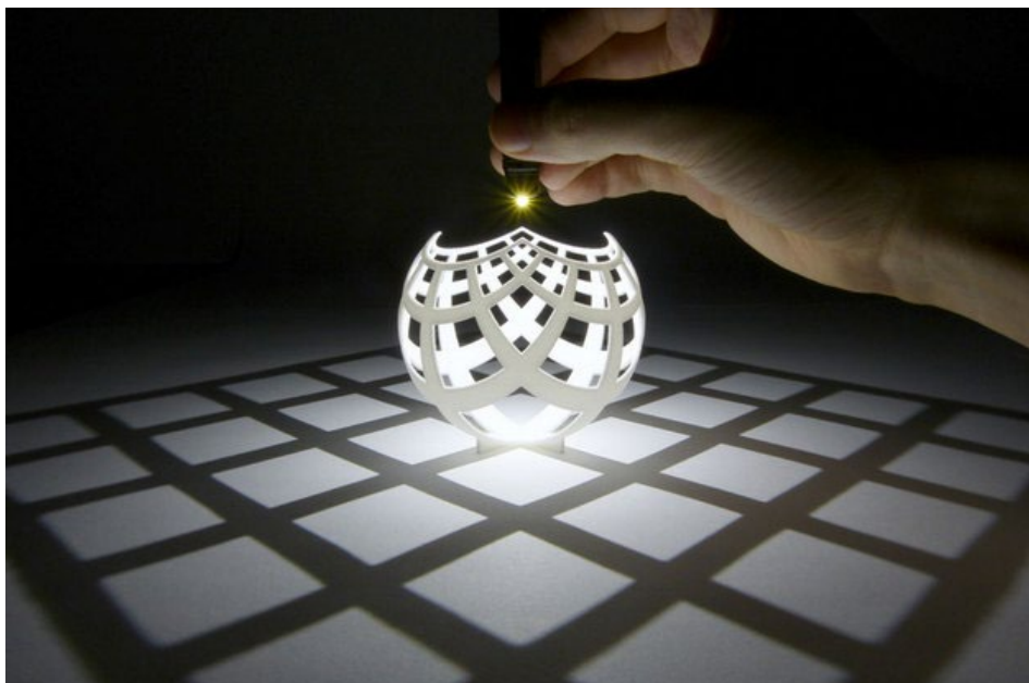
Εικόνα 10 Αντικείμενο στερεογραφικής προβολής, τρισδιάστατη εκτύπωση, το αρχείο είναι δωρεάν και προέχεται από το Thingiverse
