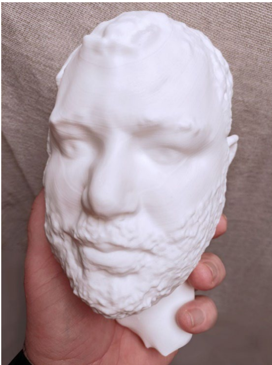
Εικόνα 17 Η πρώτη δοκιμαστική τρισδιάστατη εκτύπωση από το μοντέλο που δημιουργήθηκε στο Blender
