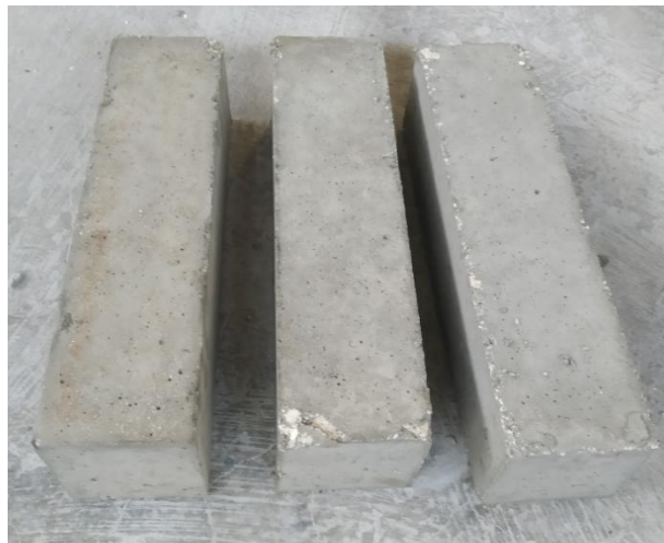
Εικόνα 11.13 Δοκίμια έτοιμα να μπούνε στις μανιέρες για 28 ημέρες
