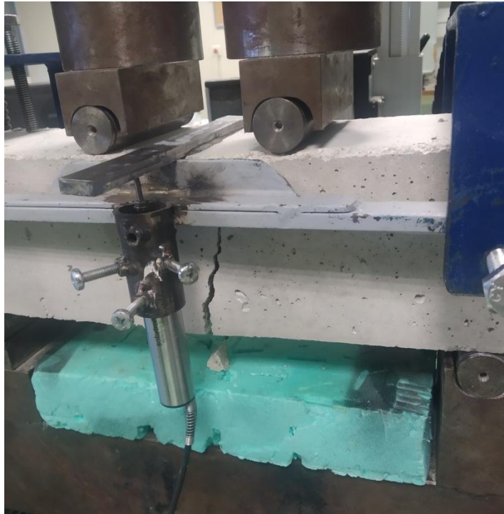
Εικόνα 11.20 Αστοχία δοκιμίου στην κάμψη
