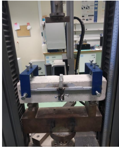
Εικόνα 11.17 Τοποθέτηση δοκιμίου στη μηχανή
