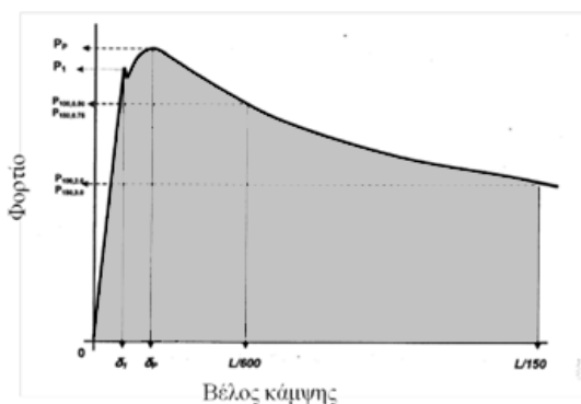
Σχήμα 11.3 Διάγραμμα Φορτίου- Βέλους κάμψης για οπλισμένο σκυροδέμα-δυσθραυστότητα, εμβαδόν περιοχής (mss-nde.uoi.gr)
