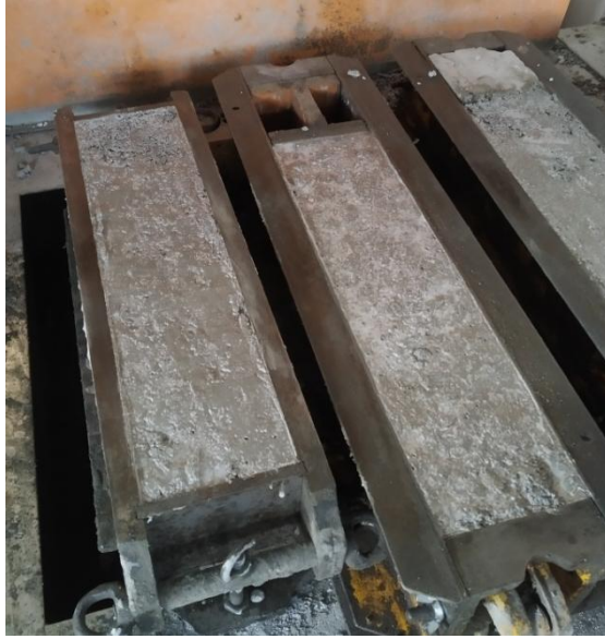
Εικόνα 11.12 Καλούπια στην τράπεζα δόνησης
