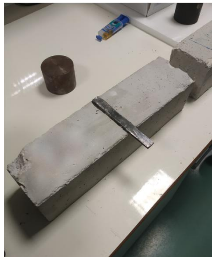
Εικόνα 11.14 Ράβδος κολλημένη με ρητίνη στο δοκίμιο
