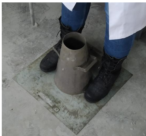
Εικόνα 11.9 Βάση και χωνί δοκιμής κάθισης
