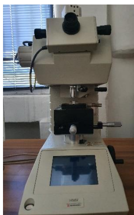
Εικόνα 7.14: Μηχάνημα μέτρησης μικροσκληρότητας SHIMADZU.
