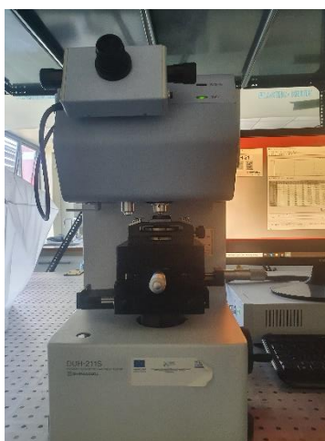
Εικόνα 7.15: Μηχάνημα μέτρησης σκληρότητας SHIMADZU στην κλίμακα νανο.
