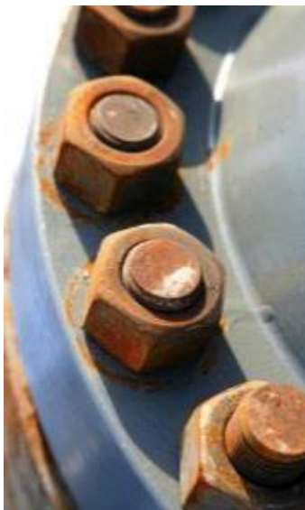
Εικόνα 5.2: Γαλβανική διάβρωση κοχλιών και περικοχλίων. 59
