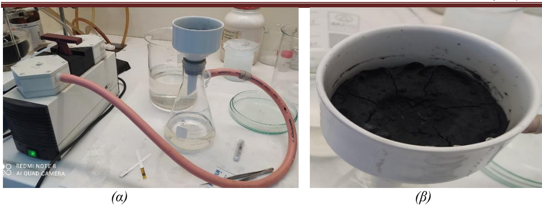
Εικόνα 17: (α) Εξοπλισμός που χρησιμοποιήθηκε (β) Κεραμικό φίλτρο κατά τη διαδικασία της έκπλυσης
