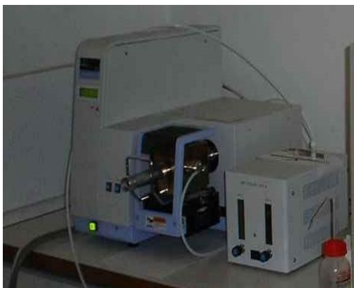
Εικόνα 10: (α) Διαφορικός Θερμικός Αναλυτής Perkin-Elmer Pyris-Diamond. (β) Σχηματικό διάγραμμα ενός τυπικού οργάνου για διαφορική θερμική ανάλυση. Ο θάλαμος που φιλοξενεί το δείγμα και το υλικό αναφοράς είναι σχεδιασμένος με τρόπο που επιτρέπει τη ροή ενός αδρανούς (όπως το άζωτο) ή δραστικού (όπως το οξυγόνο) αερίου.
