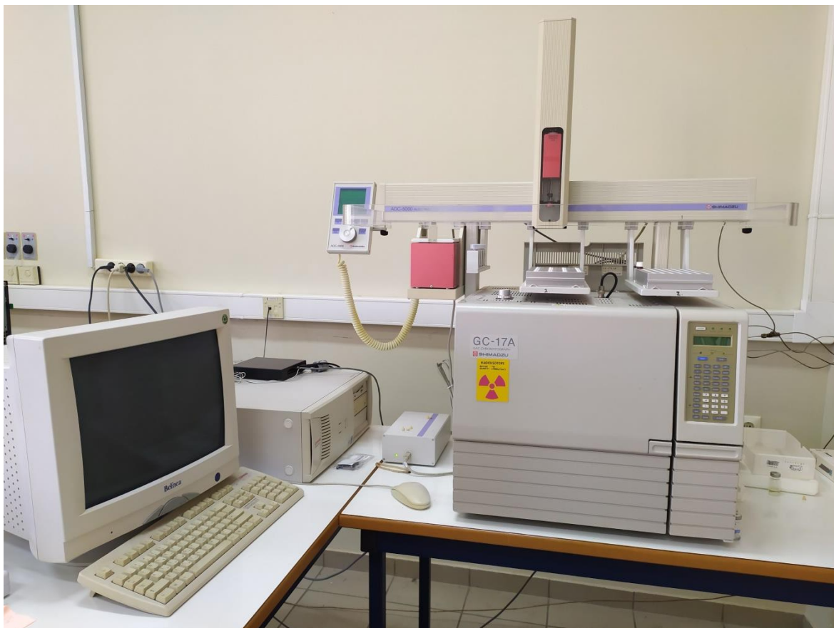
Σχήμα 17: Αέριος χρωματογράφος τύπου Shimadzu GC 17A με σύστημα αυτόματου δειγματολήπτη τύπου AOC-5000.
