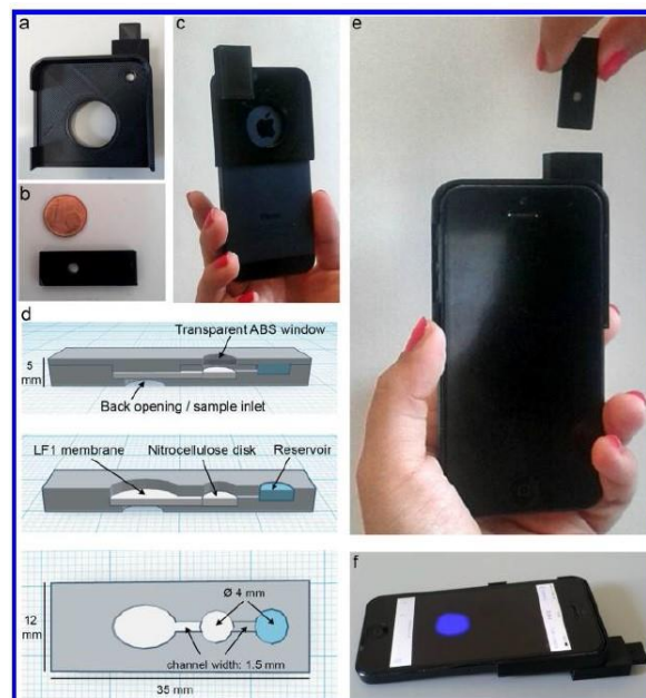
Σχήμα 13. Εικόνες των 3D εκτυπωμένων εξαρτημάτων για την ανάπτυξη φορητής συσκευής προσδιορισμού της χοληστερόλης στον ορό του αίματος και των ολικών χολικών οξέων στον ορό του αίματος και στο σάλιο 56 .
