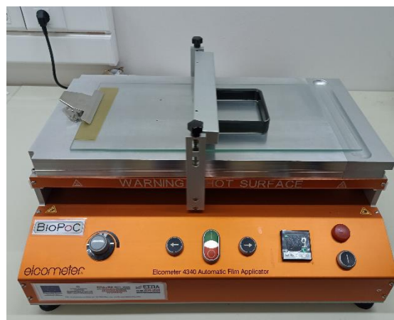
Σχήμα 16. Κατασκευή μεμβρανών με το μηχανικό επάλειπτρο υγρής στρώσης.
