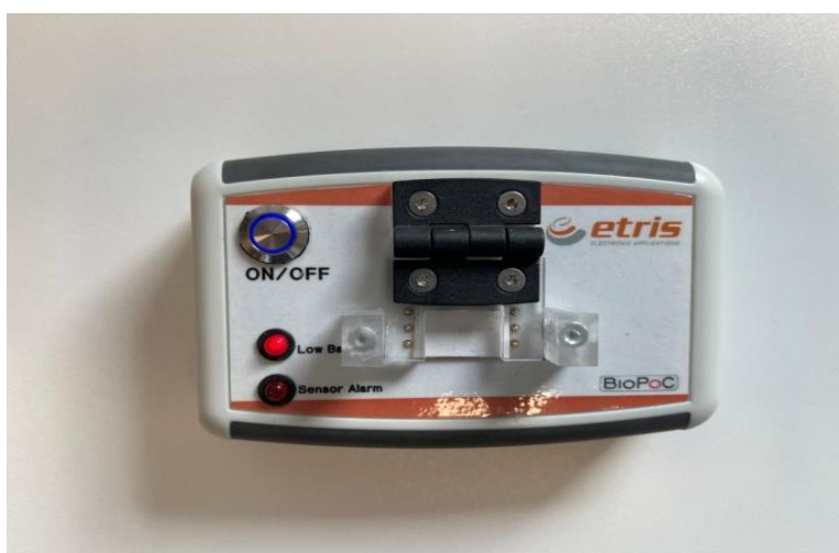
Σχήμα 37. Συσκευή BioPoC για τον προσδιορισμό του H. Pylori .
