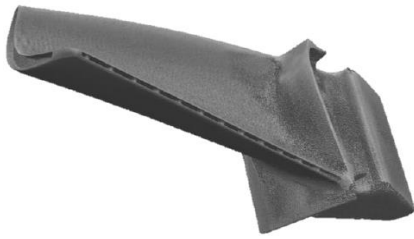
Εικόνα 1.2.2 Λεπίδα τουρμπίνας με τεχνολογία SLM (Selective Laser Melting) [15]
