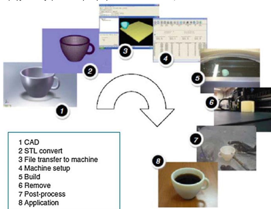
Εικόνα 1.1.2 Διαδικασία προσθετικής κατασκευής αντικειμένου από CAD αρχείο, έως το τελικό αποτέλεσμα [6]
