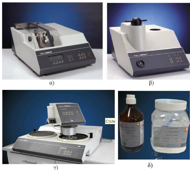
Εικόνα 3.3.1 α) Συσκευή κοπής Accutom-5, β) Συσκευή εγκιβωτισμού Laborpress-1, γ) Συσκευή λείανσης Rotorol-25 δ) Kit υγρού εγκιβωτισμού Presi, αποτελούμενο από εποξειδική ρητίνη σε σκόνη και σκληρυντικό υγρό (ακρυλικός καταλύτης).
