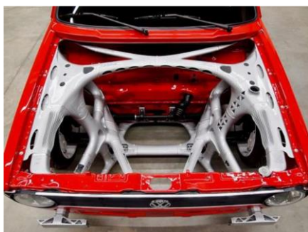
Εικόνα 1.2.5α Το έργο συνεργασίας 3i-PRIN δημιουργεί τη τρισδιάστατη εκτυπωμένη δομή του μπροστινού τμήματος ενός κλασικού VW Caddy 1 [18]
