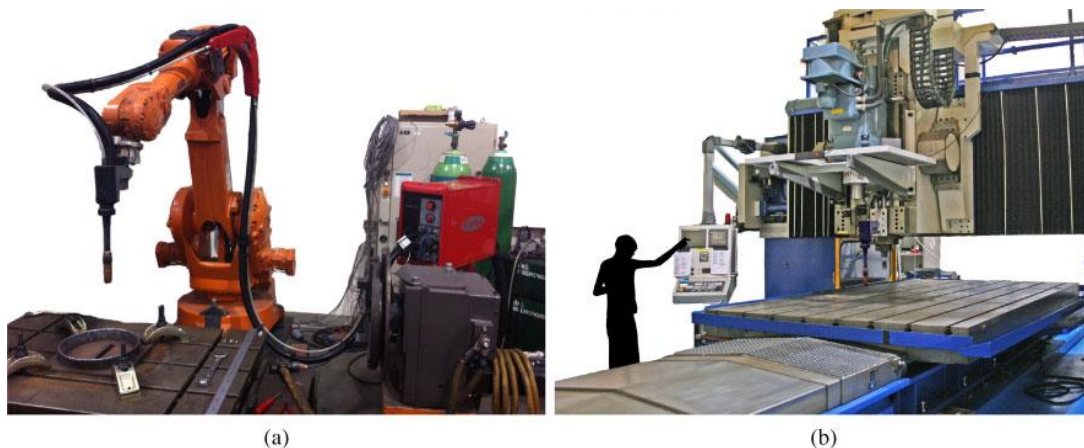
Εικόνα 2.1.3 (α) Ρομποτικός βραχίονας 6 αξόνων ABB. (β) σύστημα εναπόθεσης τοποθετημένο εκ των υστέρων σε πρώην μηχανή συγκόλλησης ανάδευσης με τριβή (friction stir welding machine) [26]
