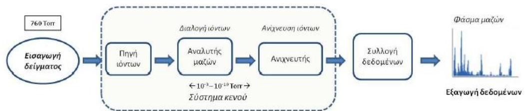
Εικόνα 5: Σχηματικό διάγραμμα οργανολογίας ενός φασματόμετρου μαζών.
