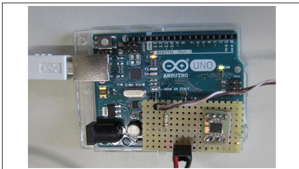
Εικόνα 5. Η βάση του Arduino UNO με την πρόσθετη πλακέτα για την ενίσχυση του σήματος της φωτοδιόδου.
