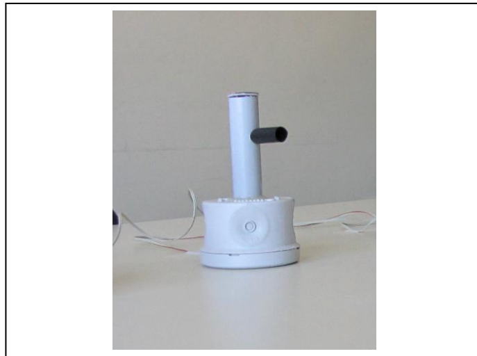
Εικόνα 6. Μία από τις ιδιοκατασκευές που περιέχουν ένα LED το οποίο οι μαθητές τοποθετούν σε τυχαίο σημείο της διαδρομής του κινητού.
