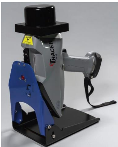
Σχήμα 26. Αριστερά) Το φασματοσκόπιο Tracer 5i πάνω σε σταθερή βάση που ώστε να χρησιμοποιηθεί ως σταθερό φασματοσκόπιο εργαστηρίου. Δεξιά) Το Tracer 5i κατά τη διάρκεια μετρήσεων στο πεδίο ("TRACER 5 pXRF spectrometer", 2022).
