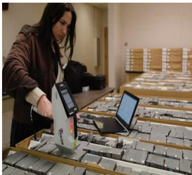
Σχήμα 26. Αριστερά) Το φασματοσκόπιο Tracer 5i πάνω σε σταθερή βάση που ώστε να χρησιμοποιηθεί ως σταθερό φασματοσκόπιο εργαστηρίου. Δεξιά) Το Tracer 5i κατά τη διάρκεια μετρήσεων στο πεδίο ("TRACER 5 pXRF spectrometer", 2022).
