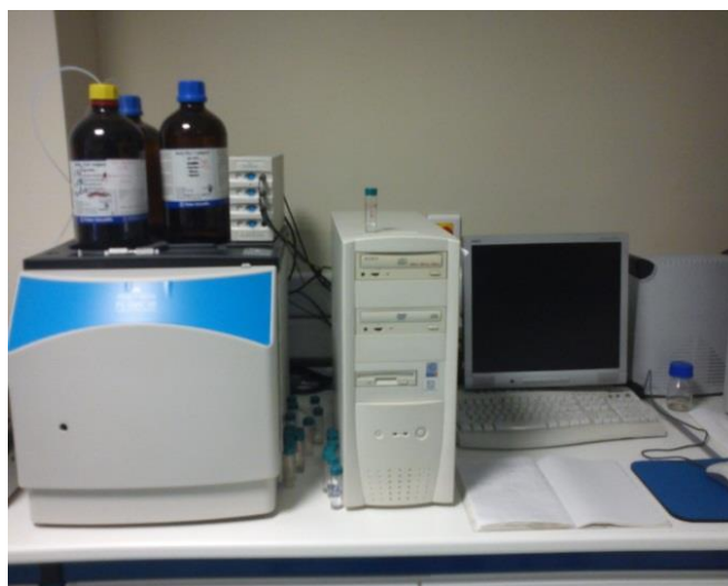
Εικόνα 6. Διάταξη οργανολογίας χρωματογράφου αποκλεισμού μεγεθών PL-50
