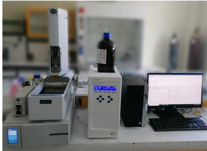
Εικόνα 29. Απεικόνιση του συστήματος της HPLC που χρησιμοποιήθηκε στην παρούσα μελέτη.
