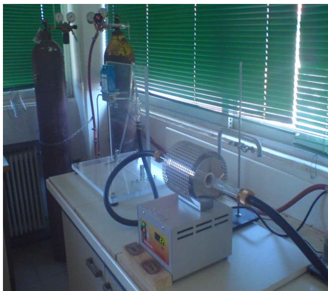
Εικόνα 30: Σωληνωτός φούρνος με τον οποίο θερμαίνονται τα δείγματα σε αδρανή ατμόσφαιρα (με ροή αδρανούς αερίου Ar)
