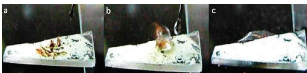
Σχήμα 1.3.2.3a Εικόνες κατά την διαδικασία αυτό-καθαρισμού της επιφάνειας με NMOF-1 (a) πριν τον καθαρισμό, (b) προσθήκη σταγόνας νερού και (c) καθαρισμός της επιφάνειας μετά την απομάκρυνση της σταγόνας νερού.
